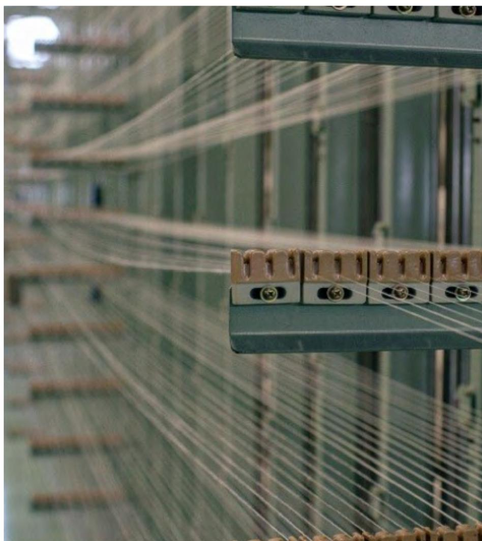
Ilustración 2: Hilos en curdo de la urdimbre / Proceso de tejeduría. Fuente: (Mil dedales, 2016)
