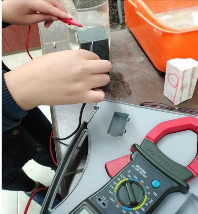
Figura 2.12 Medición de la resistencia eléctrica- Cojitambo
