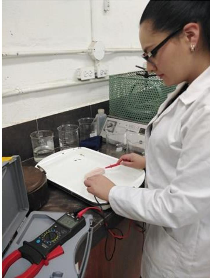
Figura 2.14 Medición de la resistencia eléctrica- Pumayunga
