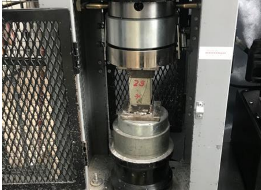
Figura 0.7 Ruptura de las probetas para determinación de la RCS. Fuente: Elaboración Propia
