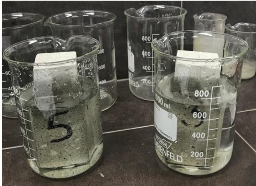
Figura 0.5 Proceso de absorción de las probetas. Fuente: Elaboración Propia
