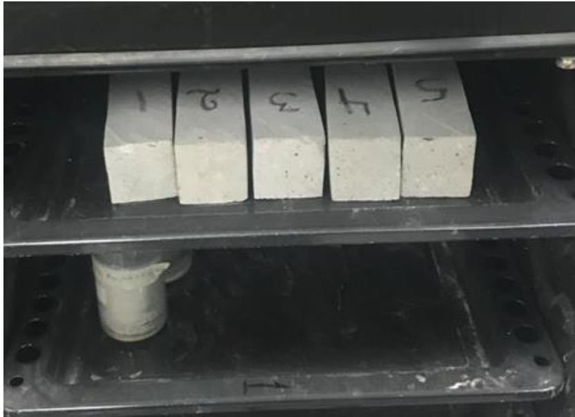
Figura 0.4 Proceso de secado de las probetas Fuente: Elaboración Propia
