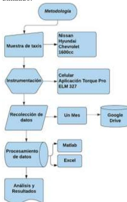
**Figura 3.** Diagrama de flujo del proceso de adquisición y procesamiento de datos.
