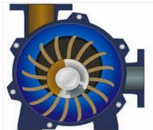
Figura 1.6 Compresor de bomba de vacío
