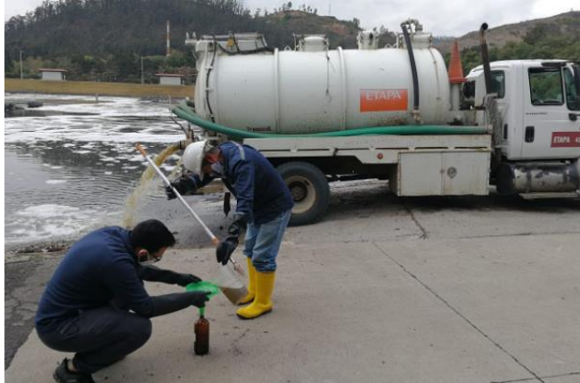
Figura 2.9. Colocación de la muestra en el frasco. Fuente: Calle y Padrón (2020)
