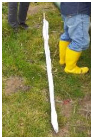
Figura 2.4. Colocación de la toalla blanca en el tubo de acero. Fuente: Calle y Padrón (2020)
