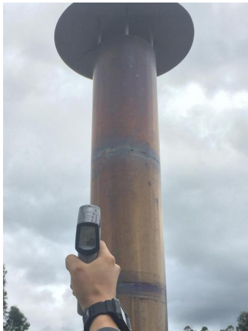
Figura 3.14 Toma de temperatura a la salida del escape del motor de biogás
