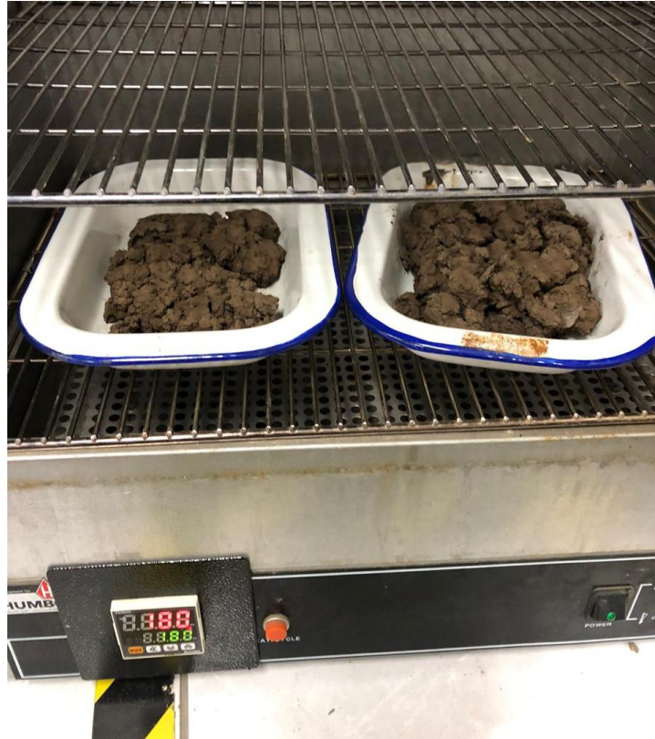
Figura 4.7 Los lodos residuales colocados en bandeja para su secado térmico
