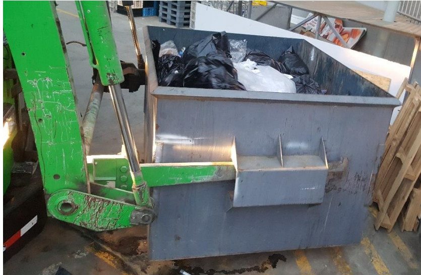
Imagen 1.3 Recolección del contenedor por el vehículo de carga frontal.
