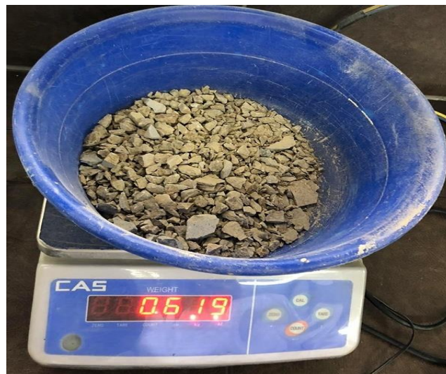
Figura 2.14 Partículas obtenidas del proceso de trituración y pesadas en la balanza.
