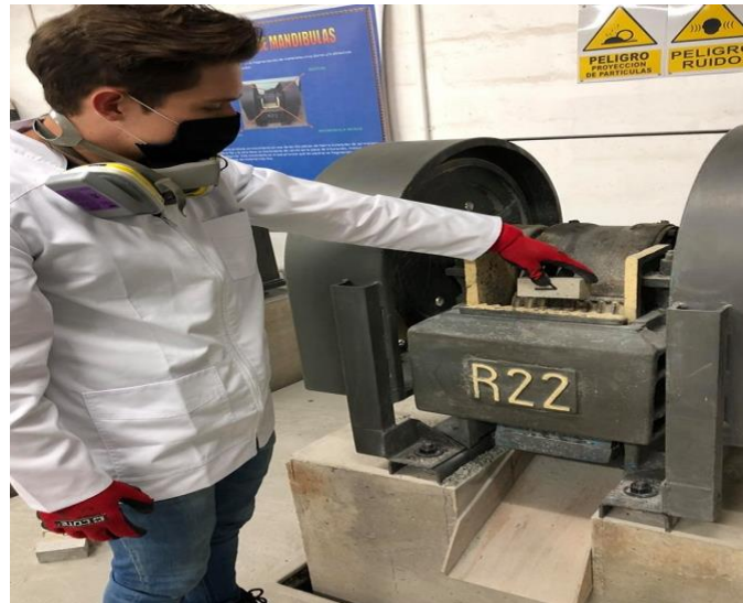
Figura 2.13 Colocación de la muestra en la trituradora de mandíbulas R22.
