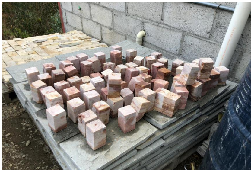
Figura 2.8 Muestras totales de la formación “Racar” (Travertino, mármol rosa)
