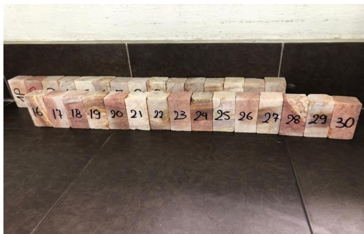
Figura 2.22 Muestras hermanas de la formación “Racar” (mármol rosa) para estudio de compresión simple.
