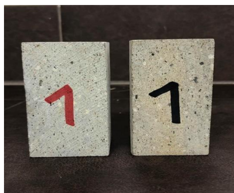
Figura 2.6 Probetas hermanas de la formación “Cojitambo” (Andesita), las cuales serán llevadas al laboratorio.
