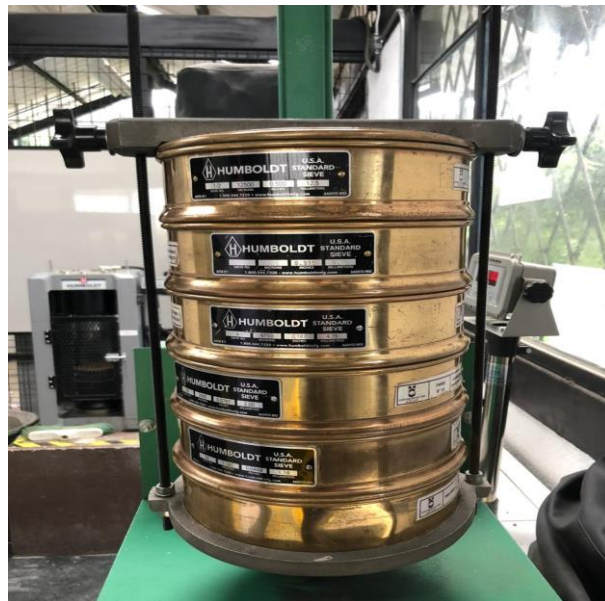
Figura 2.15 Proceso de clasificación de los tamices colocados en la tamizadora eléctrica.
