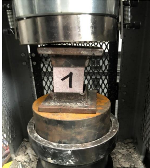
Figura 2.23 Colocación de muestra que será sometida a compresión simple.
