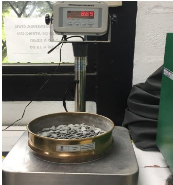
Figura 2.17 Pesado del tamiz 3/8.
