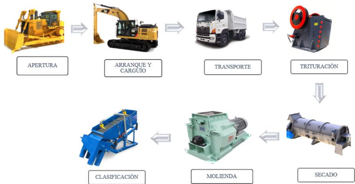
Figura 2.2 Representación gráfica de proceso de producción en minas de caolín.
