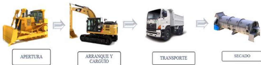
Figura 2.1 Representación gráfica de proceso productivo en minas de arcilla.
