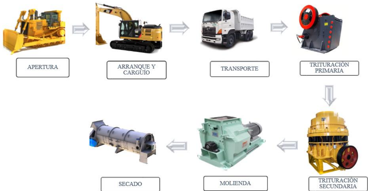
Figura 2.3 Representación gráfica de proceso de producción en minas de feldespatos.
