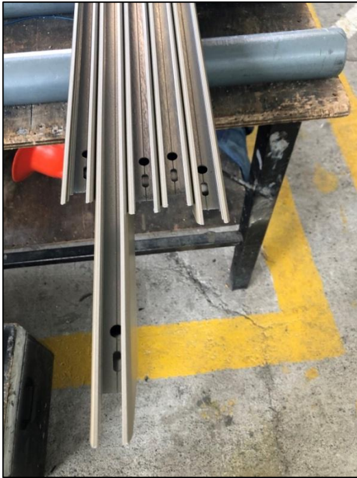
Figura 29. Puerta corredera europea: perfiles perforados
