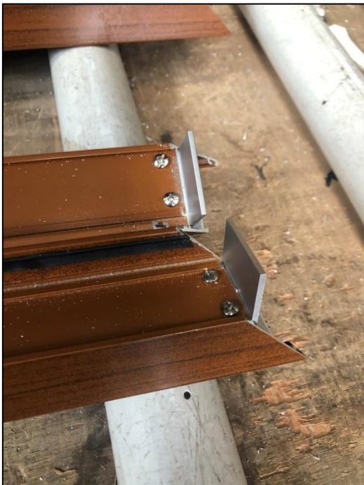
Figura 51. Ventana proyectable: anclajes en hojas y marco
