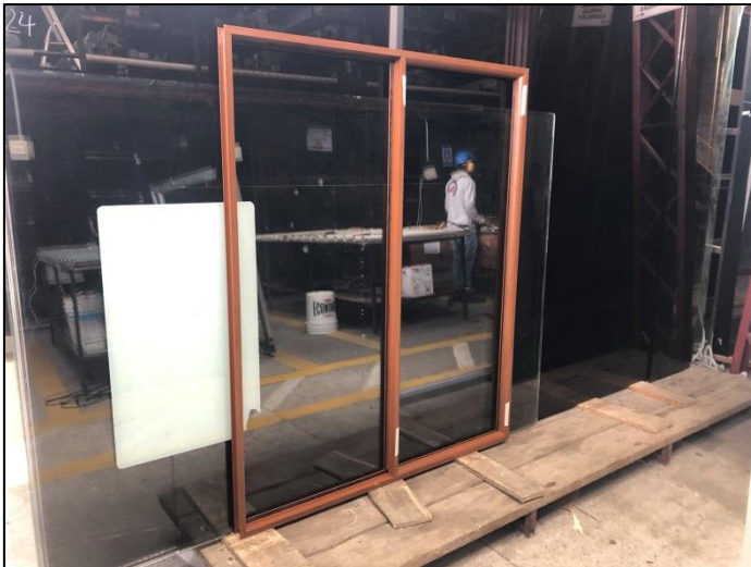
Figura 61. Ventana proyectable: marco doble ensamblado
