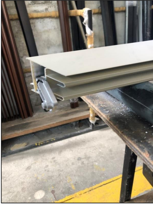
Figura 37. Puerta corrediza europea: anclas colocadas en el marco
