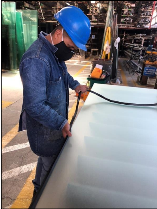
Figura 39. Puerta corrediza europea: colocación de vinil al borde del vidrio
