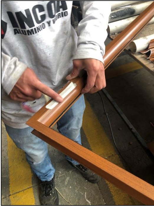
Figura 60. Ventana proyectable: colocación de junquillos
