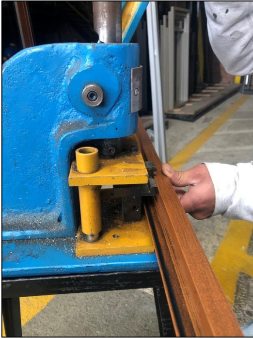
Figura 54. Ventana proyectable: troquelado para desfogue de agua
