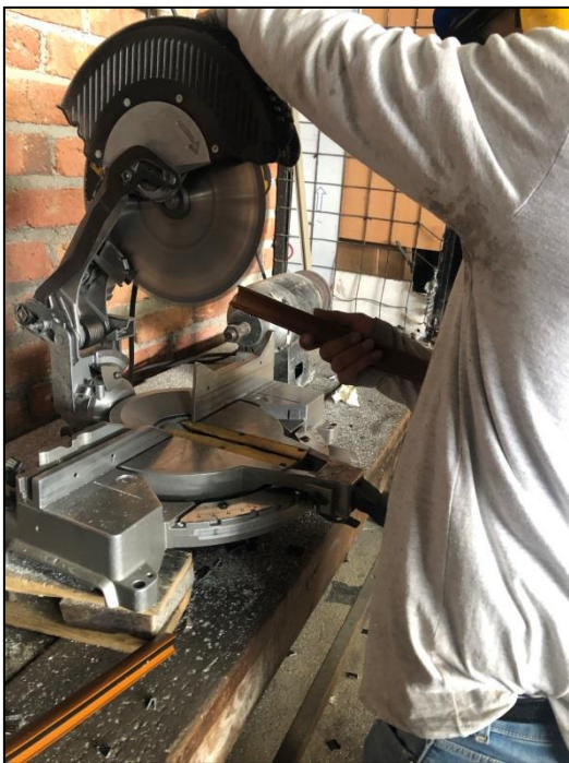
Figura 59. Ventana proyectable: destaje de junquillos
