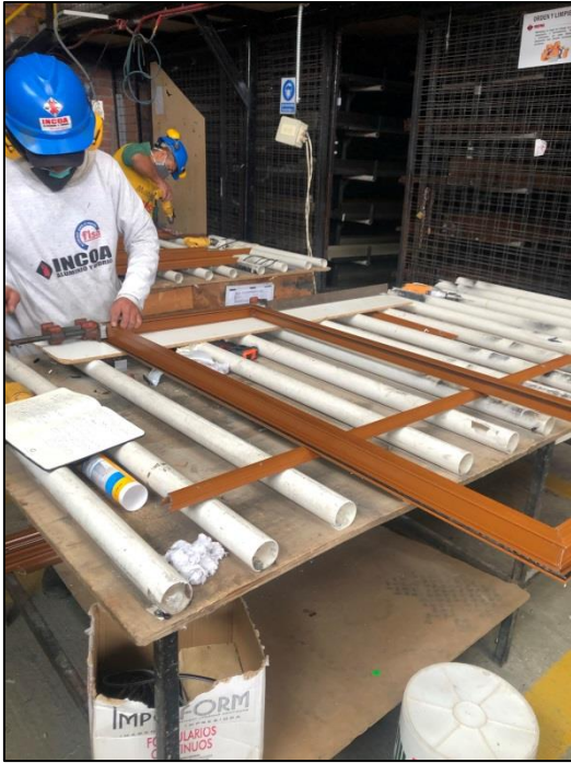
Figura 62. Ventana proyectable: ensamble de hoja con el uso de prensa
