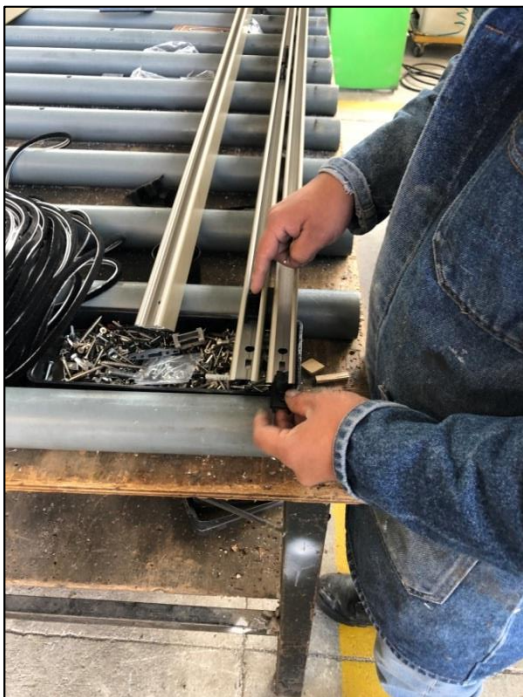
Figura 32. Puerta corrediza europea: instalación de topes y ruedas en los perfiles
