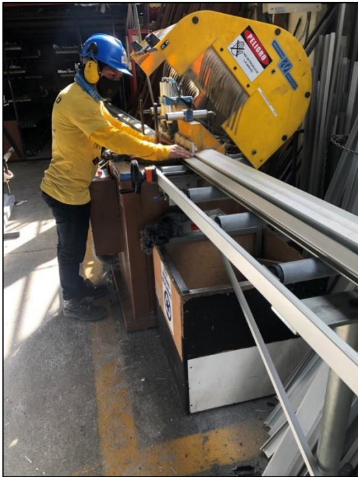
Figura 27. Puerta corrediza europea: corte de perfiles a medidas requeridas
