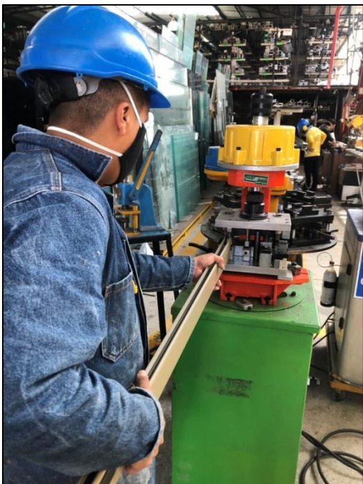
Figura 28. Puerta corrediza europea: máquina de perforaciones para anclajes
