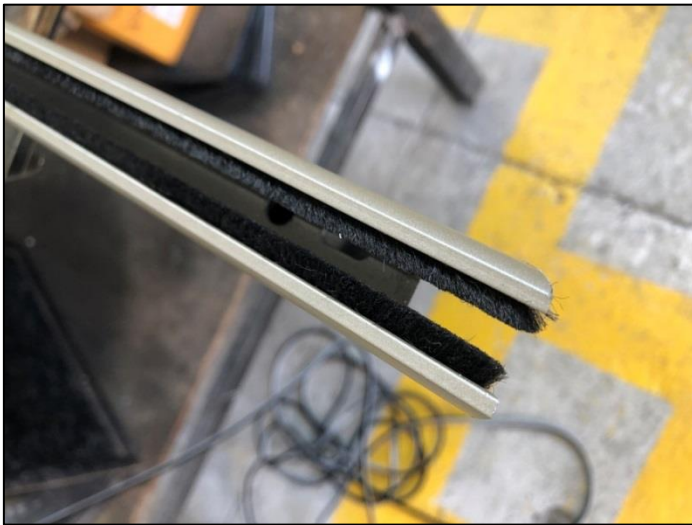
Figura 33. Puerta corrediza europea: colocación de felpa en la vena del perfil
