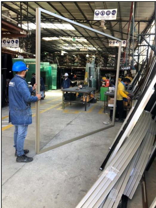
Figura 38. Puerta corrediza europea: marco armado
