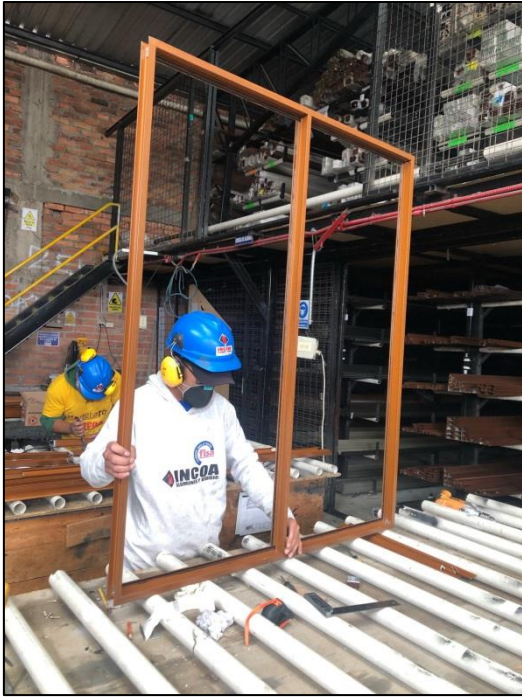
Figura 58. Ventana proyectable: instalación de división con tornillos
