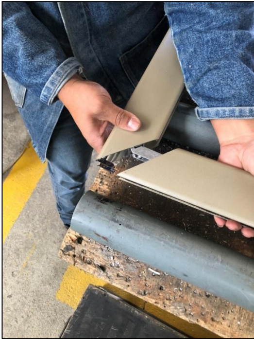
Figura 35. Puerta corrediza europea: armado de hojas
