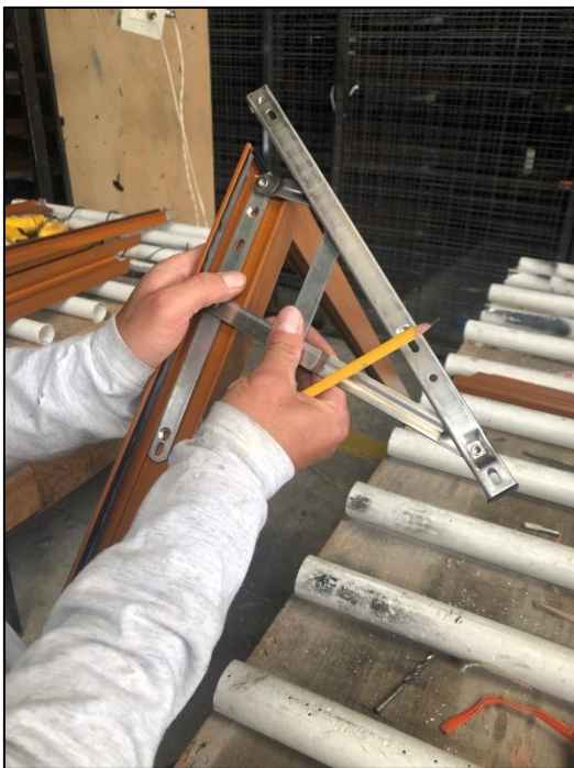
Figura 65. Ventana proyectable: instalación de brazo metálico en hoja ensamblada
