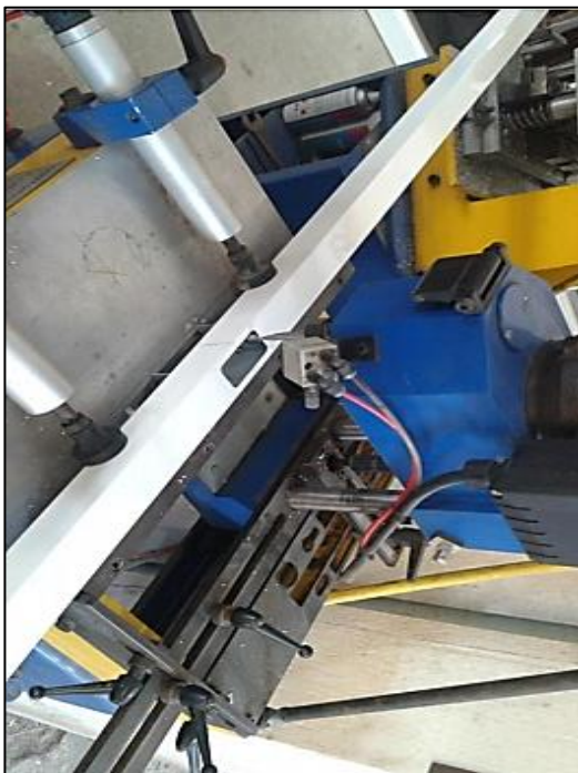
Figura 30. Puerta corredera europea: troquelado de cerradura
