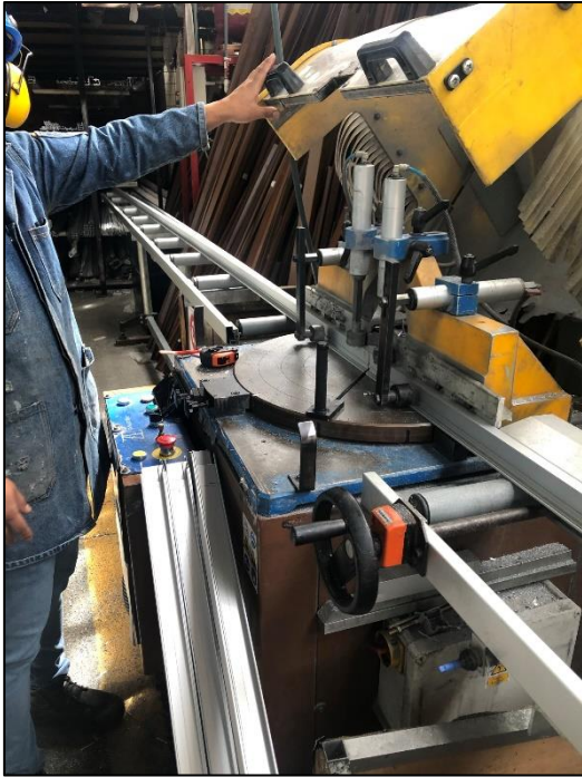
Figura 47. Ventana proyectable: corte de perfiles
