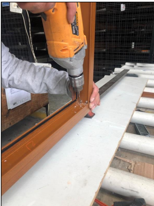
Figura 63. Ventana proyectable: perforación para ensamble de hoja
