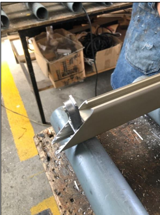
Figura 34. Puerta corrediza europea: anclas colocadas en la hoja
