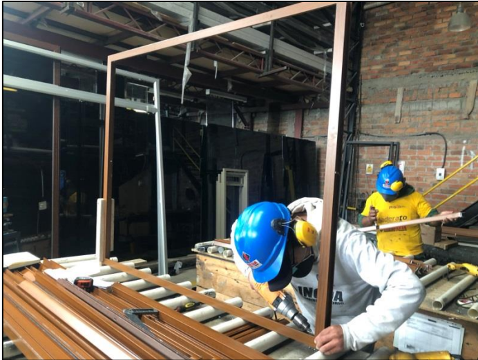
Figura 56. Ventana proyectable: proceso de ensamble de marco
