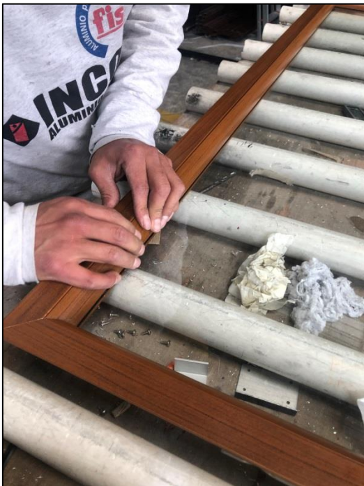
Figura 69. Ventana proyectable: ajuste y acristalamiento de estructura
