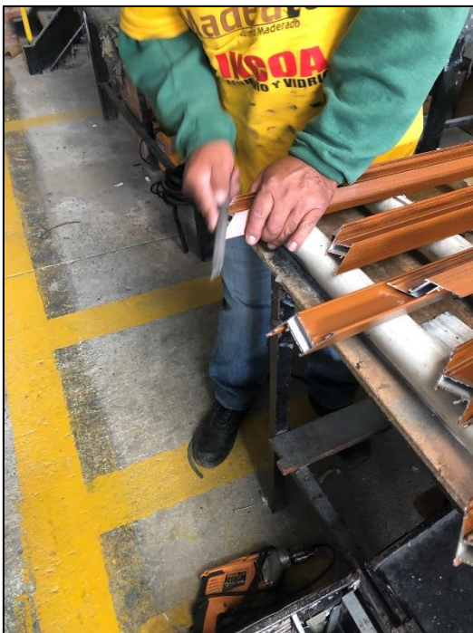
Figura 48. Ventana proyectable: verificación de medidas y limado de bordes
