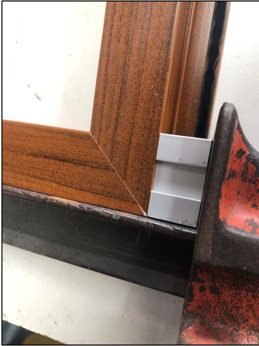
Figura 64. Ventana proyectable: ajuste de bordes para ensamblado de hoja
