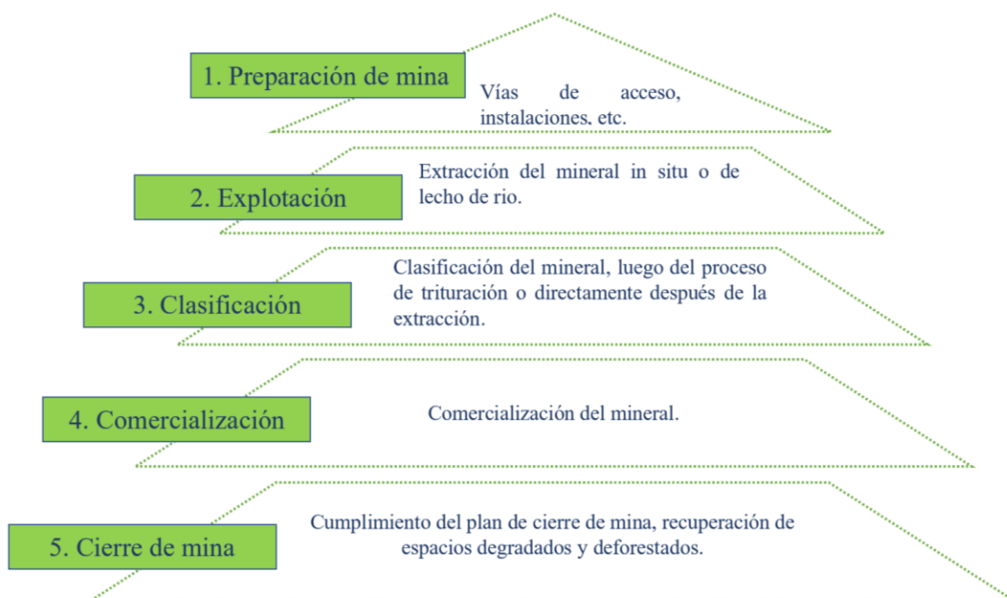
Figura 2. Fases de la minería de áridos.
