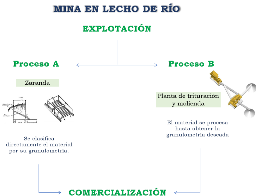
Figura 11. Procesos de producción en una mina de lecho de río.
