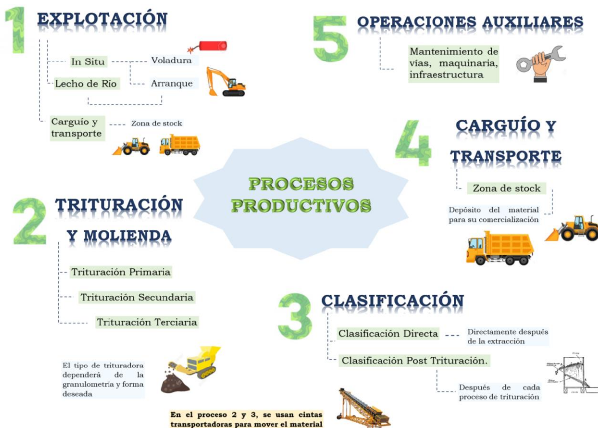
Figura 3. Procesos productivos en minería de áridos.
