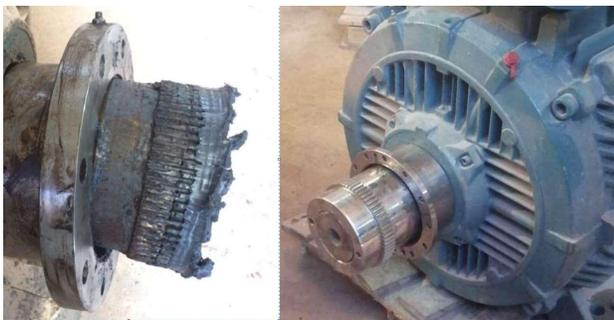
Fig. N°20. Estado de sistema de transmisión previo y posterior a la intervención. Fuente: Hivimar.
