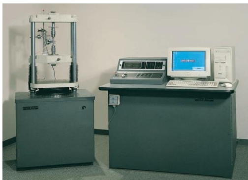
Figura 3.16. Máquina de ensayo de tracción para medir la resistencia de soldaduras (máquina de prueba de 60,000 Lb)
