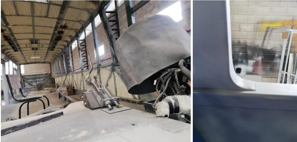
Figura 3.10. Forrado interior de un autobús interprovincial Referencia: Empresascarroceras ubicadas en la ciudad de Cuenca.
