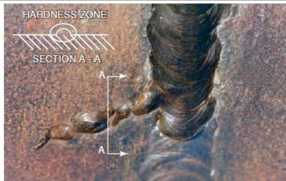
FIGURA 69. GOLPES DE ARCO Fuente: (Larry Jeffus, 2019)
