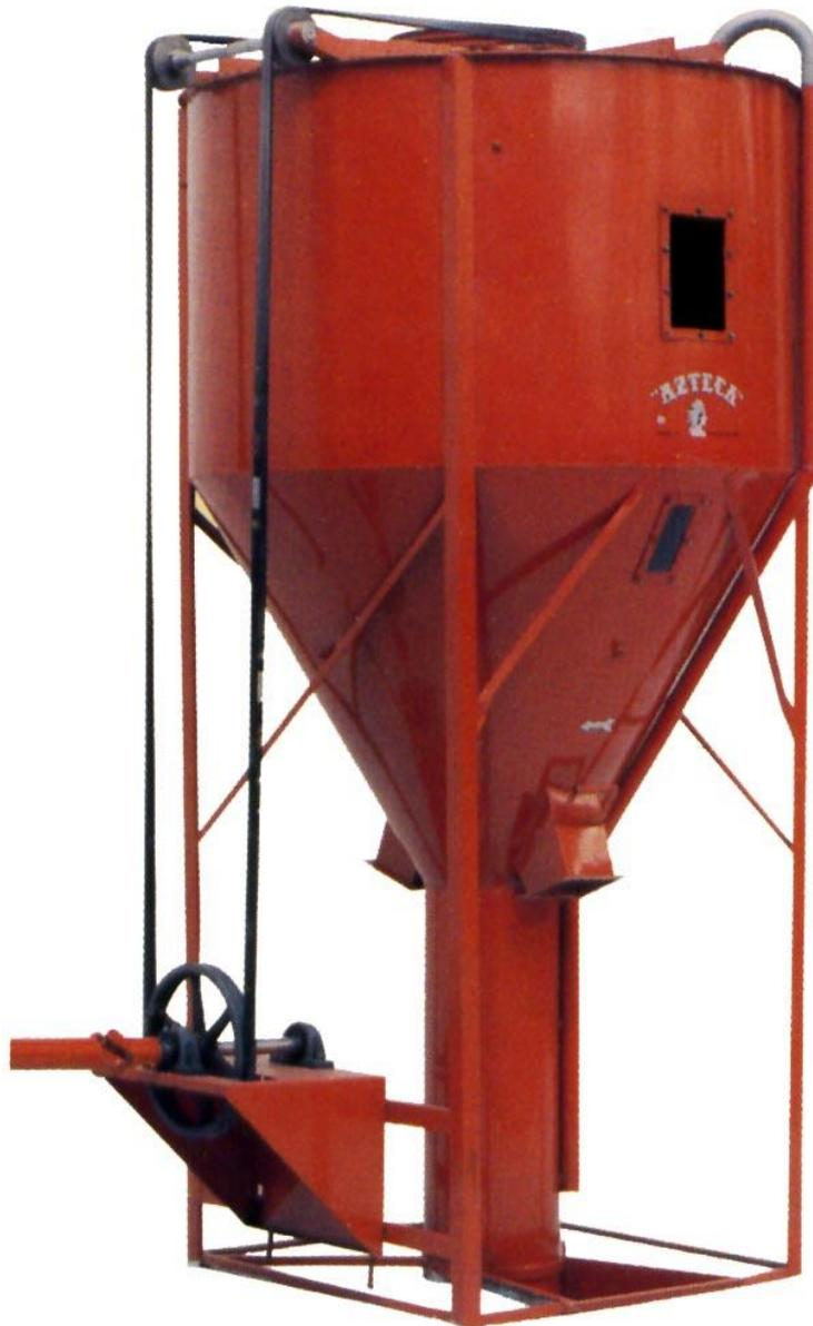
**Ilustración 3.** Mezclador vertical con motor eléctrico.
