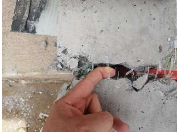
Fotografía 5-13 Resistencia presentada por fibras PET ancho 2 mm fuente: Autores.
