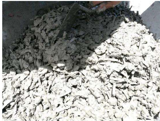
Fotografía 3-2 Mezcla de hormigón fresco con fibras plásticas. Fuente: Autores
