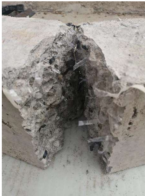
Fotografía 5-6 Elemento con fibras LDPE abierto por la mitad. fuente: Autores
