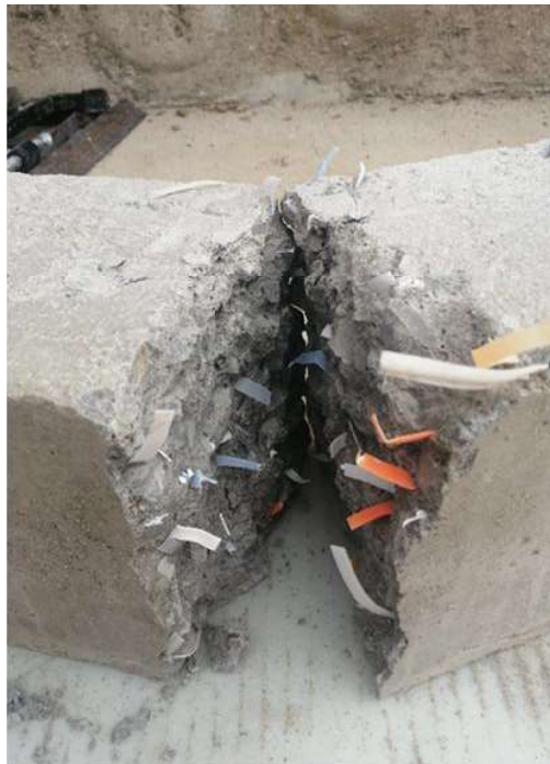
Fotografía 5-3 Elemento con fibras HDPE abierto por la mitad. fuente: Autores
