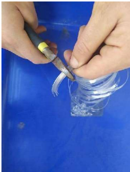
Fotografía 2-13 Cortado de Fibra plástica obtenida Fuente: Autores
