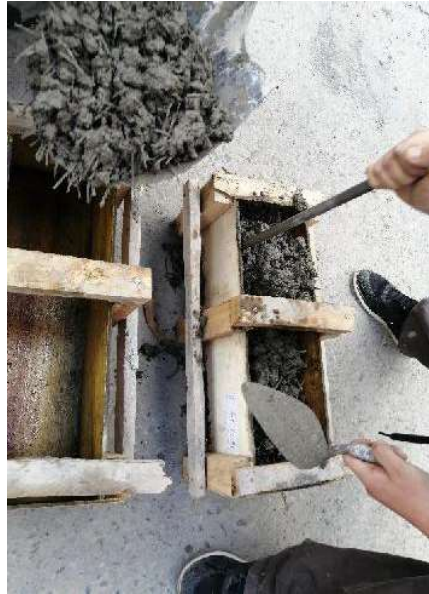
Fotografía 3-6 Compactación manual. Fuente: Autores
