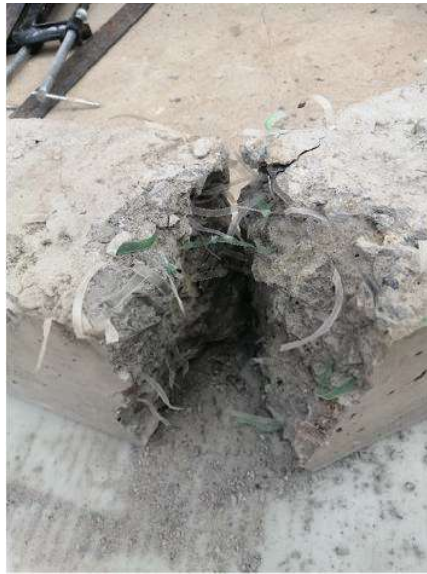
Fotografía 5-9 Elemento con fibras PET abierto por la mitad. fuente: Autores
