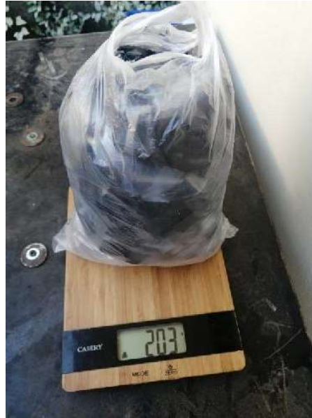
Fotografía 2-14 Estandarización de fibras para inclusión en mezcla de hormigón. Fuente: Autores
