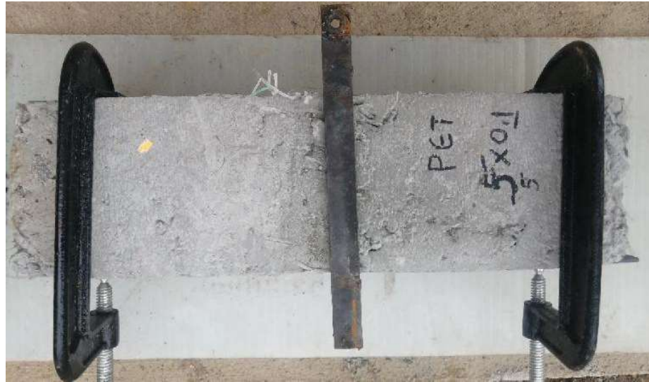
Fotografía 4-2 Ensamble de acoples en una muestra. Fuente: Autores.
