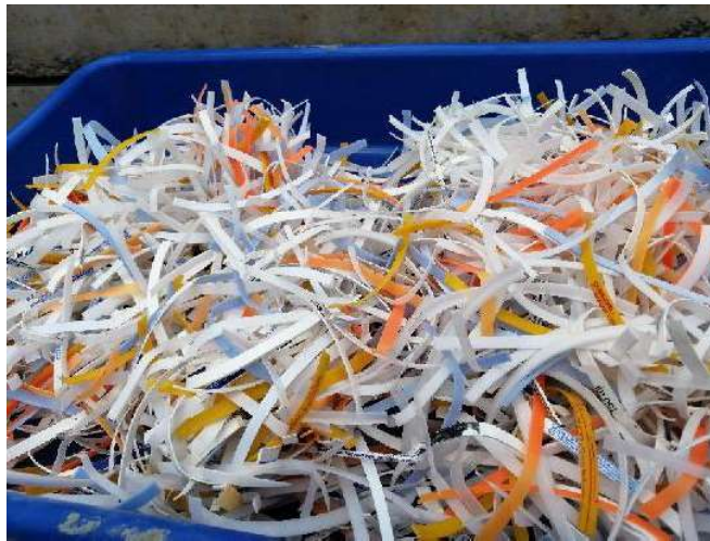
Fotografía 2-16 Fibras plásticas HDPE sin cortar para inclusión en mezcla de hormigón. Fuente: Autores
