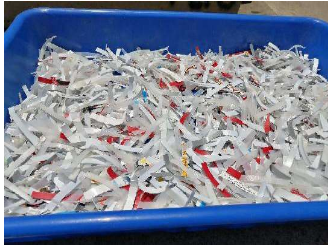
Fotografía 2-15 Fibras plásticas HDPE para inclusión en mezcla de hormigón. Fuente: Autores
