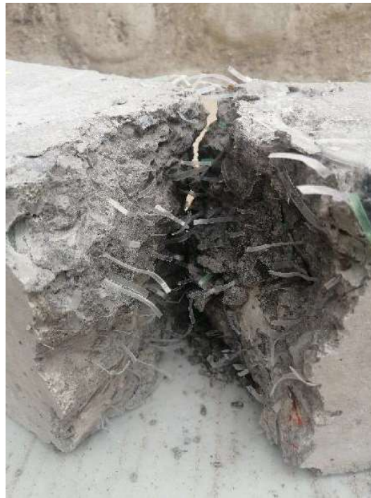
Fotografía 5-12 Elemento con fibras PET ancho 2mm abierto por la mitad. fuente: Autores
