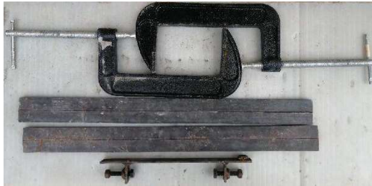
Fotografía 4-1 Fijadores para ensayo a flexion. Fuente: Autores.
