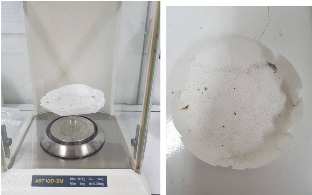
**Figura 4.** Pesado de papeles filtros con polvo sedimentable
