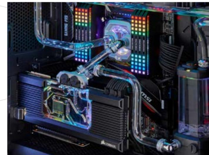
Imagen 24. Refrigeración líquida completa
