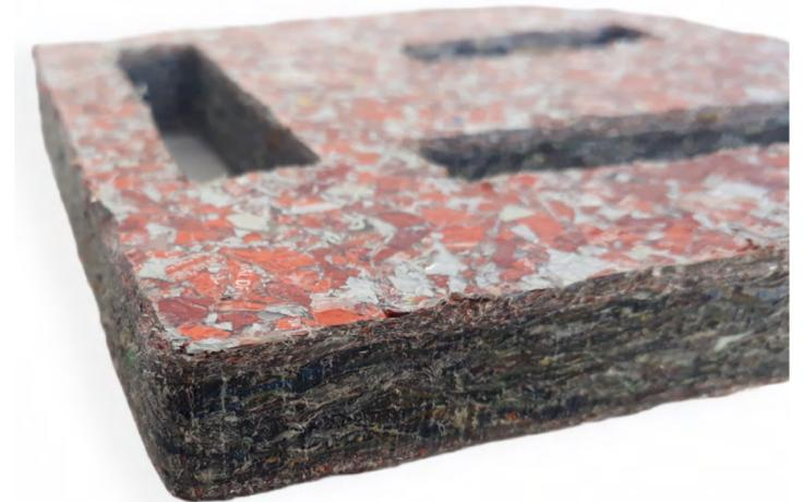
IMAGEN 37 Detalle de corte por router CNC
