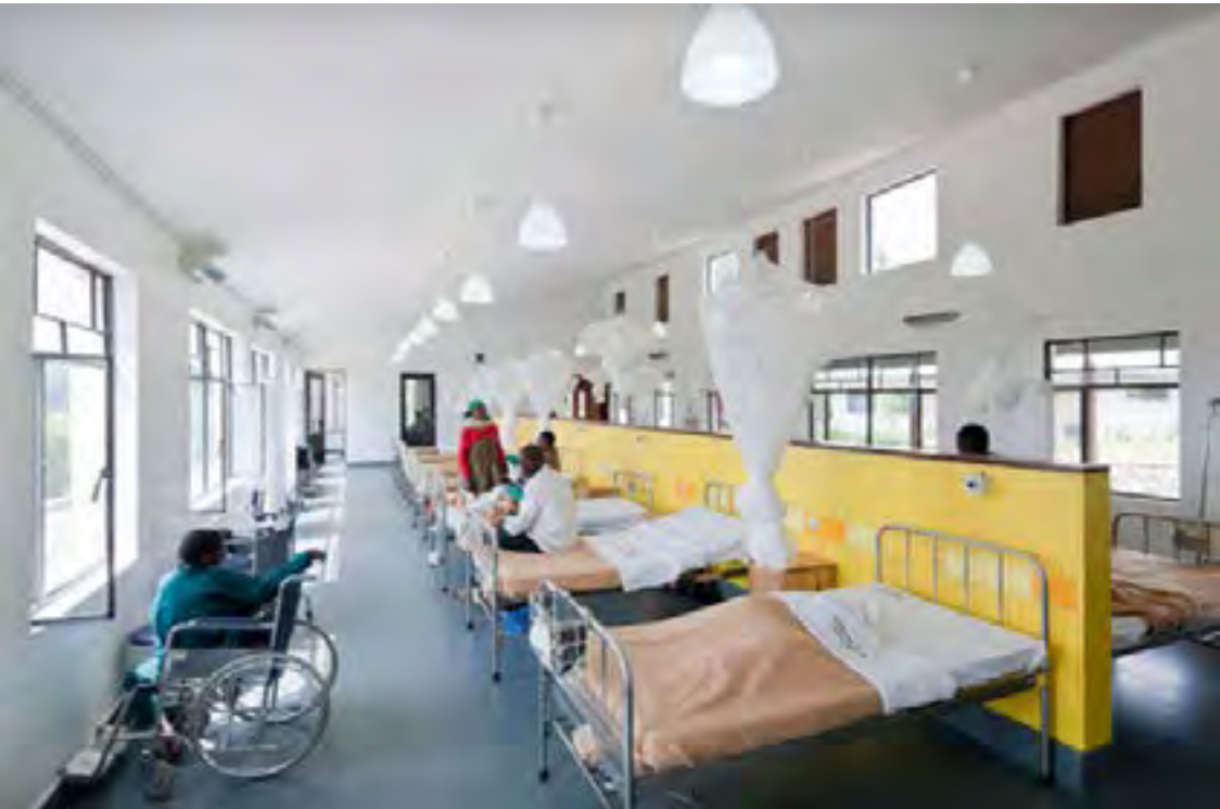
Imagen 68: Ventilación Cruzada Autor: Plataforma Arquitectura
