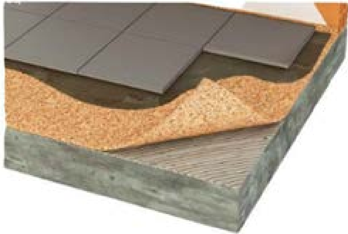
Figura 130. Plancha de corcho como aislamiento
