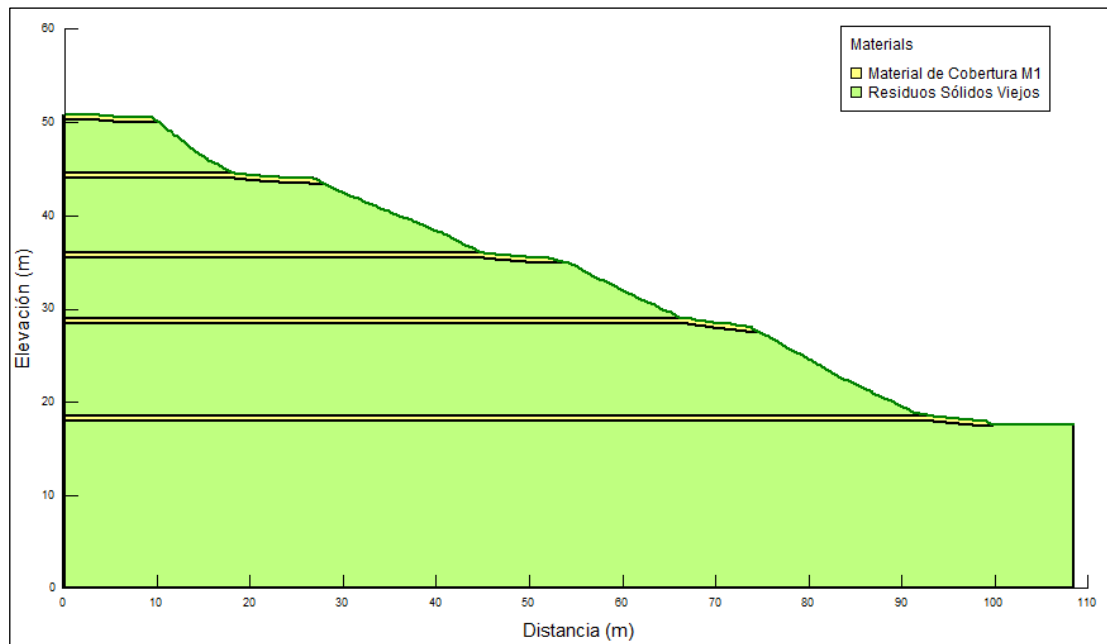
Figura 4.6. Taludes y terrazas del perfil 5 del Relleno Sanitario de Pichacay.
