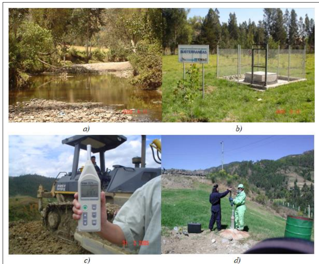
Figura 2.22. Monitoreo ambiental del relleno sanitario: (a) calidad de agua superficial; (b) calidad de agua subterránea; (c) ruido ambiental; (d) emisiones gaseosas.
