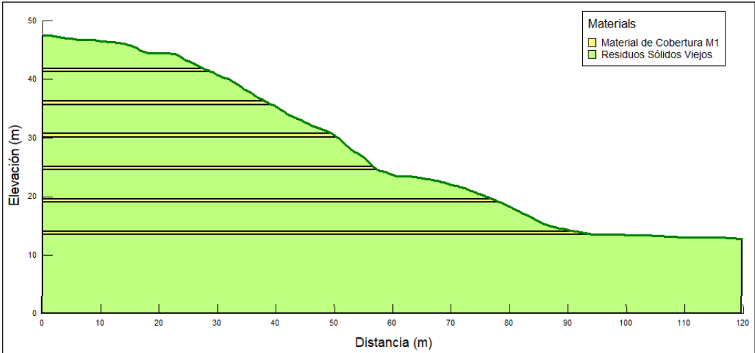
Figura 4.3. Taludes y terrazas del perfil 2 del Relleno Sanitario de Pichacay.
