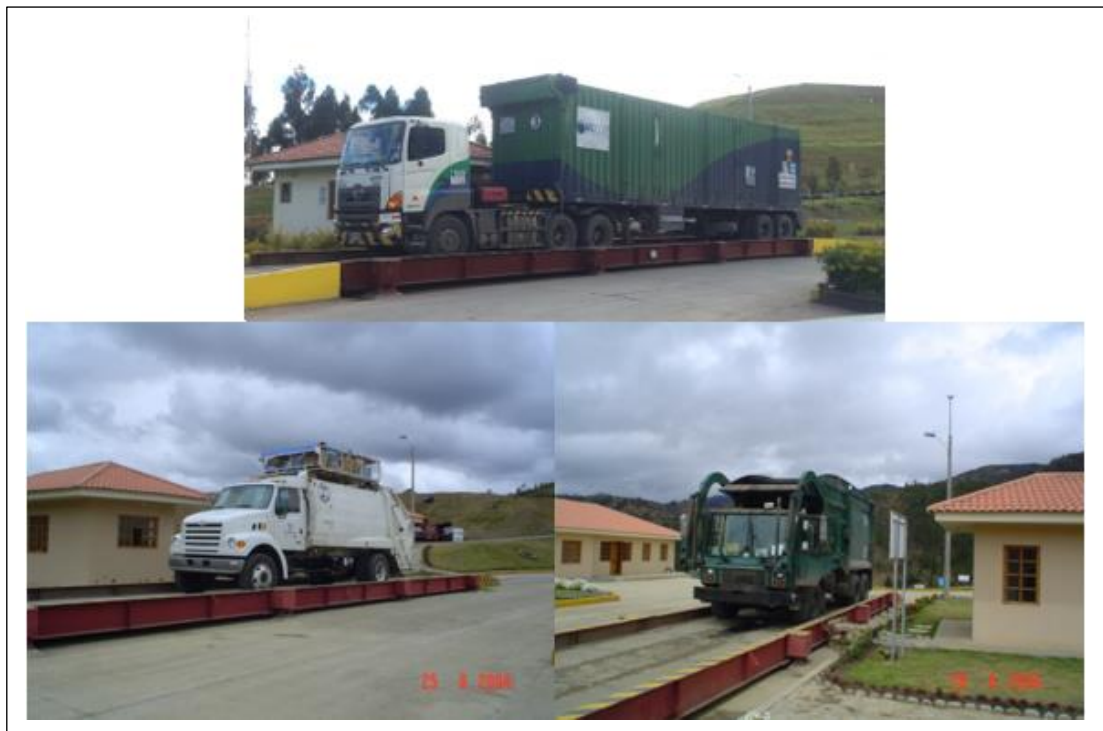
Figura 2.13. Pesaje de los vehículos al ingreso y salida del relleno.
