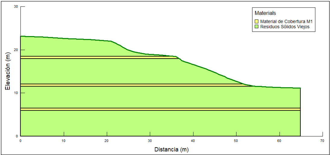
Figura 4.2. Taludes y terrazas del perfil 1 del Relleno Sanitario de Pichacay.
