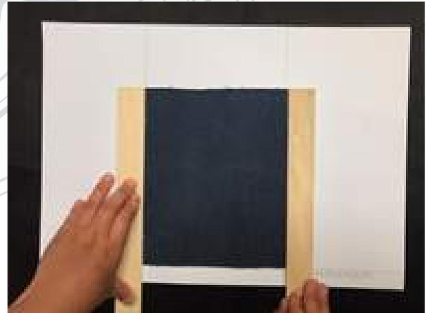
Pegar con cinta adhesiva la muestra de 20 cm x 20 cm en la cara opuesta de las dos reglas usando 2 cm de cada lado de la tela. En la escala colocar la regla izquierda sobre la horizontal izquierda, mover la segunda regla a lo largo de la escala. Estirar hasta que la tela empiece a deformarse. Cualquier tejido que tenga una elasticidad de más de 5cm debe ser considerada de alta elasticidad y a partir de esta determinación se han hecho 5 divisiones:
