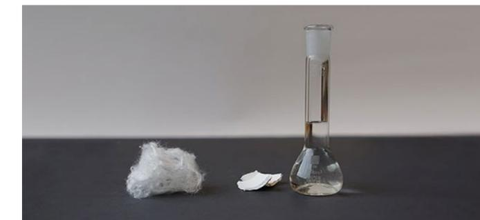
Figura22. Filamentos de viscosa a partir de residuos de algodón
