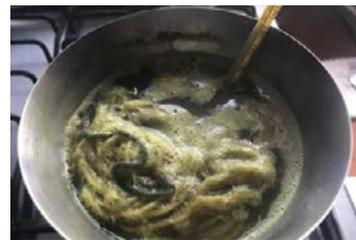
Coloca los 4 recipientes a fuego alto hasta que el termómetro marque 80 °C que es la máxima temperatura que se ocupa sin que la fibra sufra daños. Una vez esté en la temperatura establecida se baja la llama para mantenerla. Posteriormente se colocan las madejas en cada recipiente y desde ese momento con ayuda de un temporizador se deja durante 40 min. En este lapso de tiempo se debe mover constantemente la fibra.
