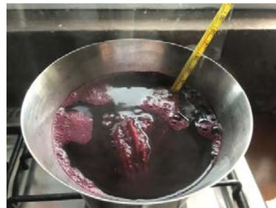
Colocar los 4 recipientes a fuego alto hasta que el termómetro marque 80 °C que es la máxima temperatura que se ocupa sin que la fibra sufra daños. Una vez esté en la temperatura establecida se baja la llama para mantenerla. Posteriormente se colocan las madejas en cada recipiente y desde ese momento con ayuda de un temporizador se deja durante 40 min. En este lapso de tiempo se debe mover constantemente la fibra.
