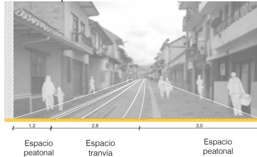
Figura 33. Sección vial tramo T04. S. Pulla
