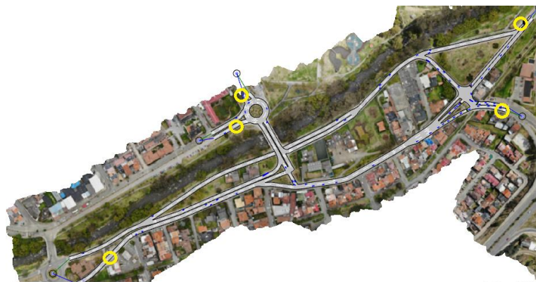
Gráfico 2.17: Colocación de detectores.
