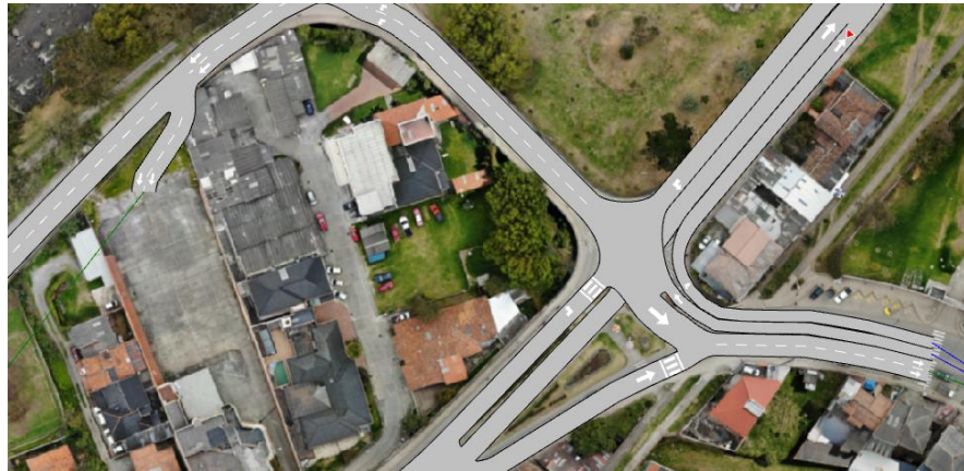
Gráfico 2.30: Vista en planta de los cambios propuestos en la intersección semafórica con la alternativa 2.
