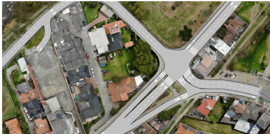
Gráfico 2.28: Vista en planta de los cambios propuestos para la intersección semafórica con la alternativa 1.
