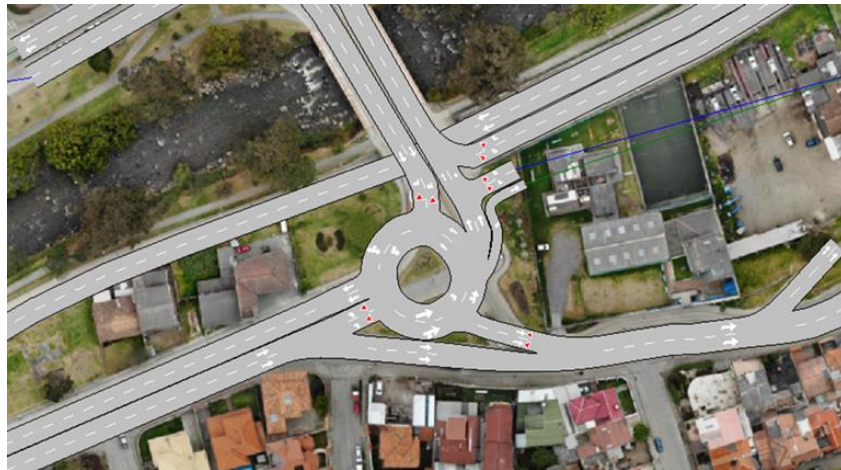
Gráfico 2.26: Vista en Planta del redondel propuesto en la alternativa 1.
