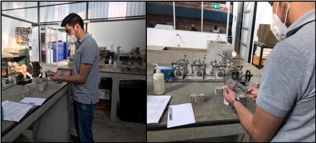
Figura 3.21. Toma de medida de las aristas de las probetas cúbicas mediante calibrador.
