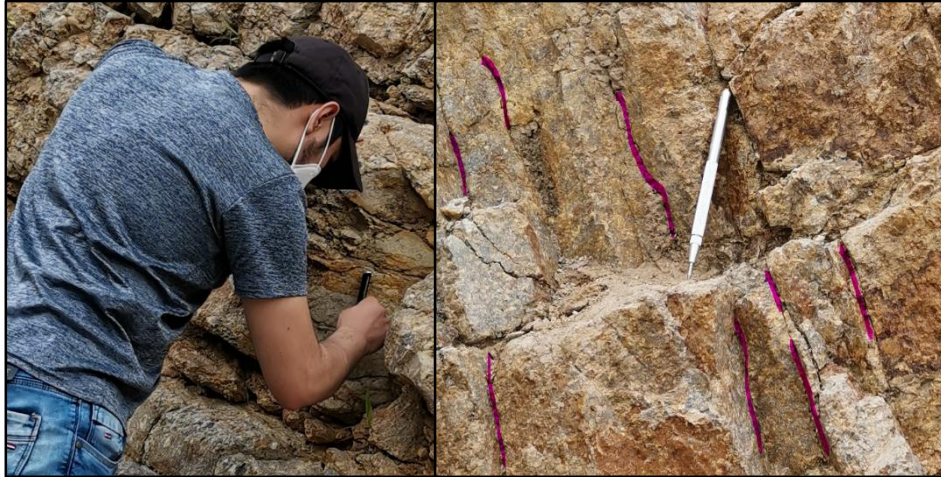
Figura 3.14. Determinación del relleno con uso del lápiz rayador.
