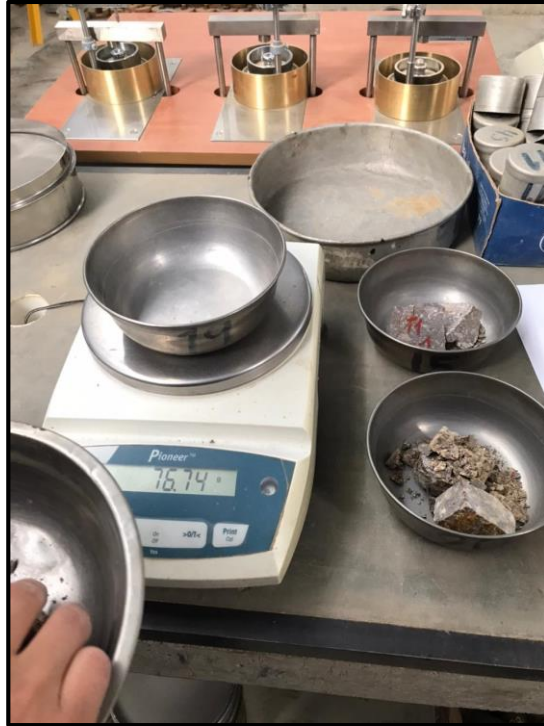
Figura 3.27. Determinación del peso natural o peso en aire.
