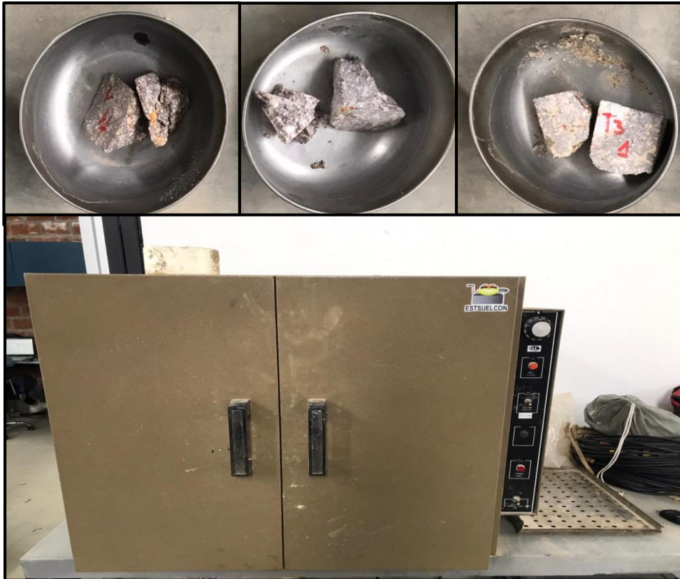
Figura 3.30. Determinación del peso en seco de cada muestra.
