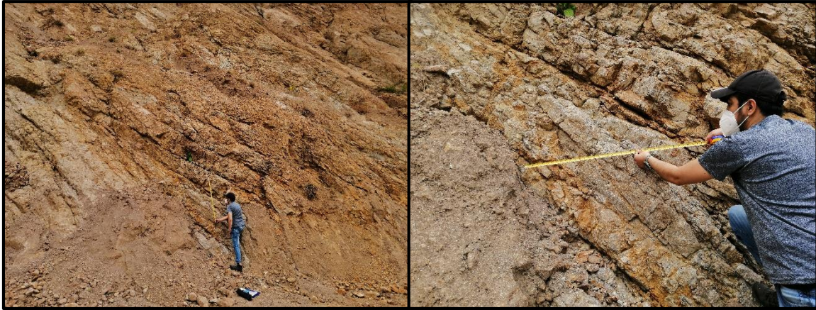
Figura 3.8. Análisis del número de juntas por metro cúbico de la estación 2 para el RQD.
