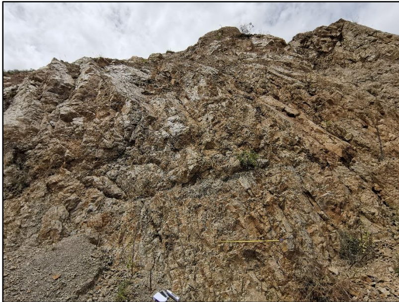
Figura 3.9. Análisis del número de juntas por metro cúbico de la estación 3 para el RQD.
