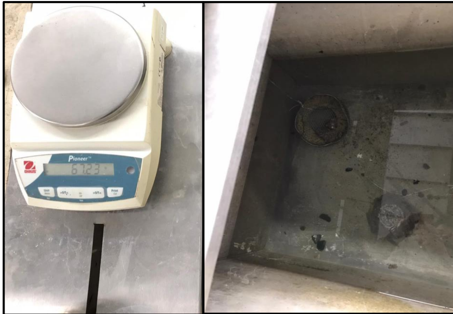
Figura 3.29. Determinación del peso sumergido.
