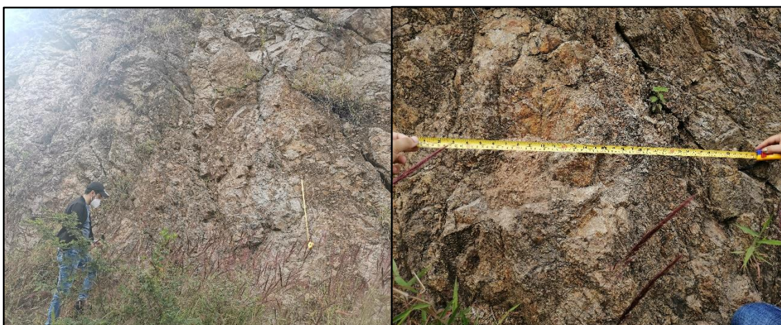
Figura 3.7. Análisis del número de juntas por metro cúbico de la estación 1 para el RQD.
