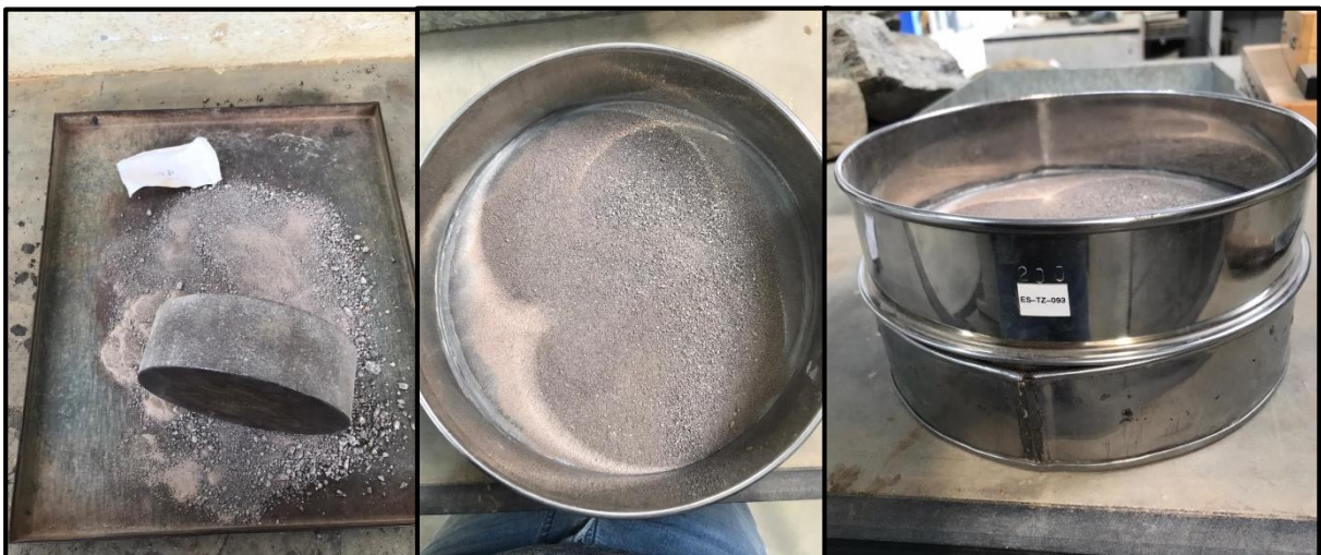
Figura 3.31. Conminución del material y paso por el tamiz #200.
