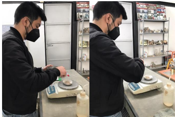
Figura 3.33. Peso del picnómetro y de los 25 g de muestra para cada ensayo.
