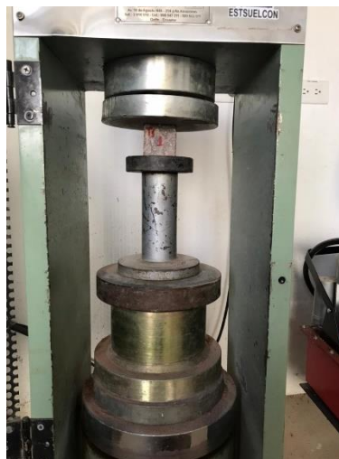
Figura 2.5. Determinación de la resistencia a la compresión simple o uniaxial.
