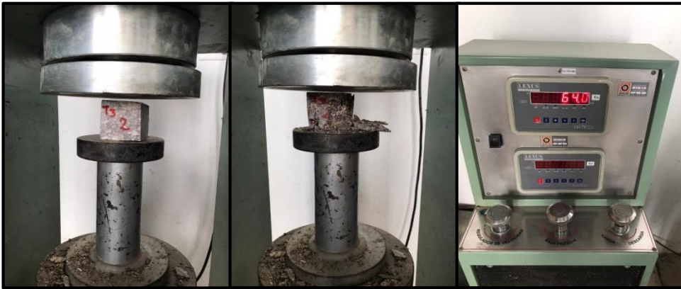
Figura 3.25. Ensayo de compresión simple aplicado a las probetas cúbicas.
