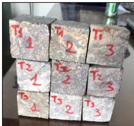
Figura 3.24. Muestras cúbicas para el ensayo de compresión simple.
