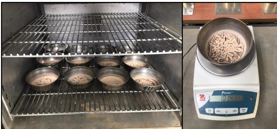
Figura 3.35. Muestras secas en la mufla y su peso en la balanza analítica.
