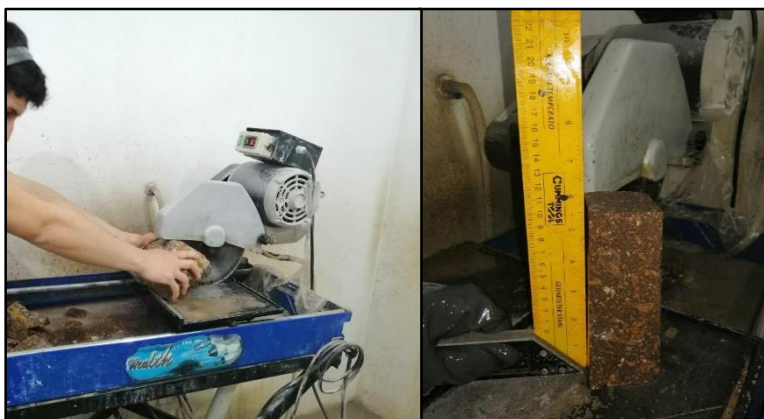
Figura 3.16. Corte y perfilación de los cubos de roca.
