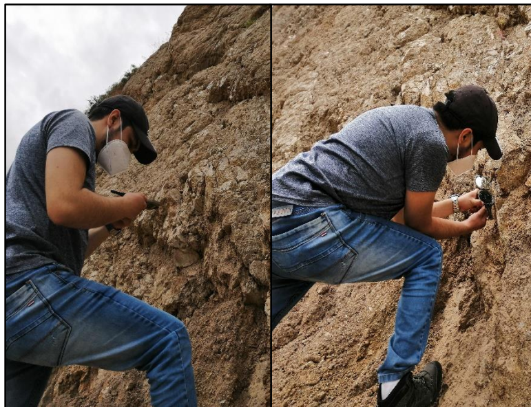
Figura 3.11. Determinación del Rumbo y Buzamiento para el cálculo de persistencia.
