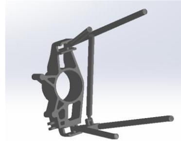
Fig. 3 Geometría final Push Rod.
