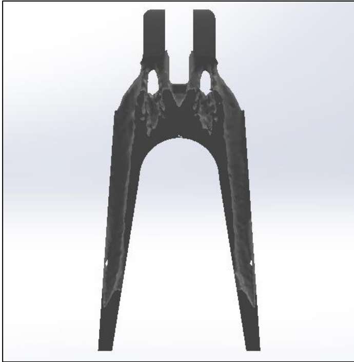
Figura 43 modelado del brazo oscilante optimizado en el plano XY.
