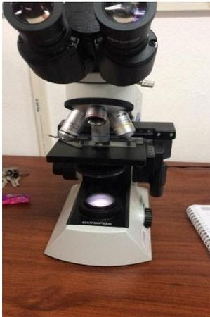
Ilustración 4. Microscopio (OLYMPUS CX21 Y OLYMPUS CH-2) con lente 40x.
