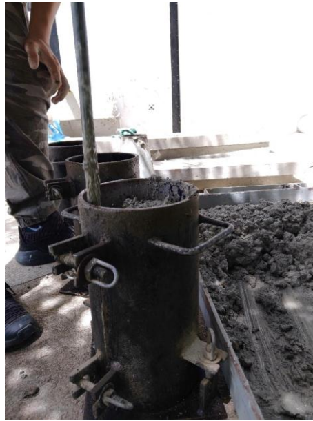
Figura 3.13: Toma de probetas de hormigón.
