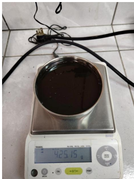
Figura 3.6: Medición de superplastificante.
