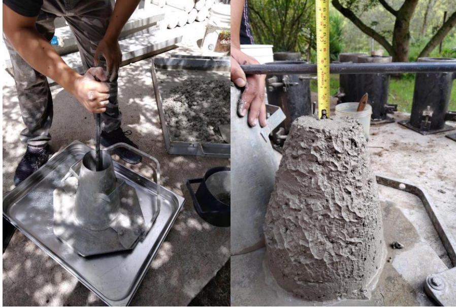
Figura 3.11: Ensayo de asentamiento con el cono de Abrams.
