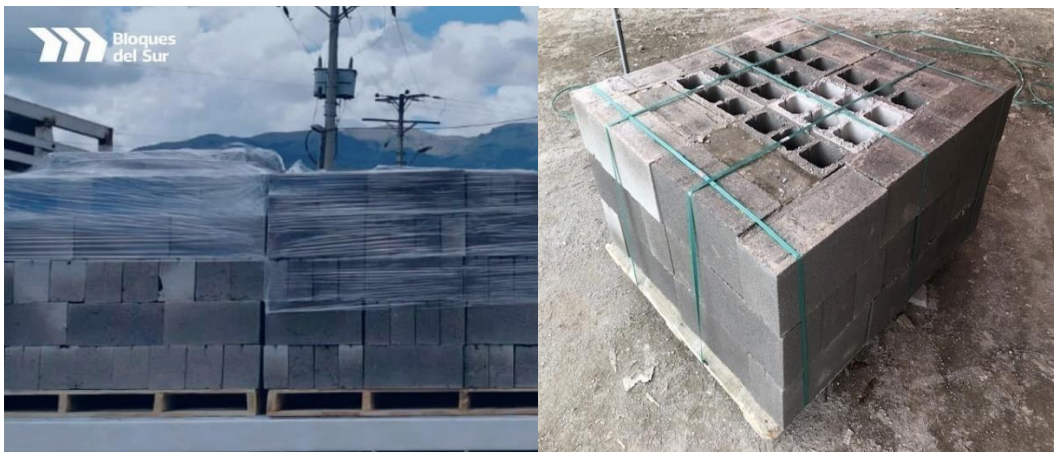
Figura 24. Pallets asegurados con plástico y con zuncho
