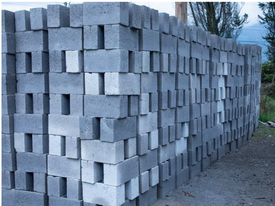
Figura 28. Apilamiento de bloques boca abajo
