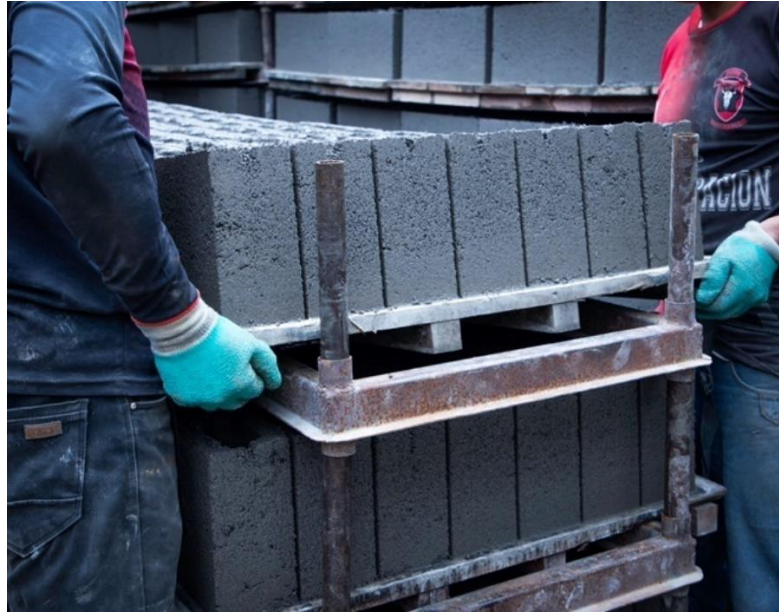
Figura 19. Omegas de hierro de la empresa Bloques del Sur
