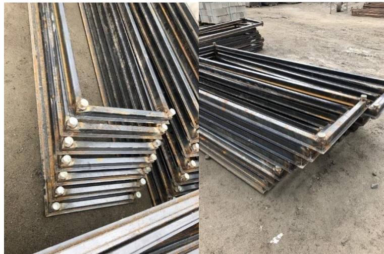
Figura 20. Omegas oxidados y omegas tratados
