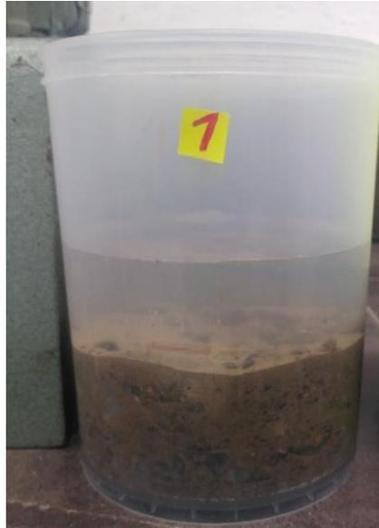
**Figura 2.11.** Ensayo de permeabilidad-Muestra 1
