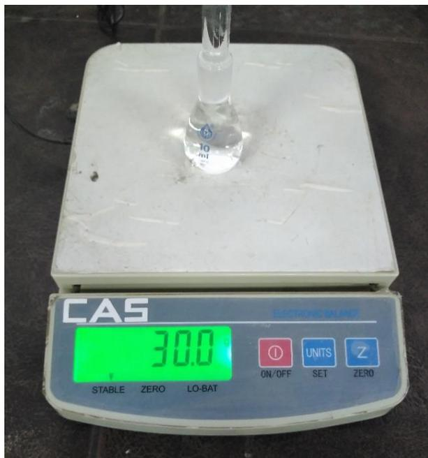
**Figura 2.1.** Picnómetro con agua
