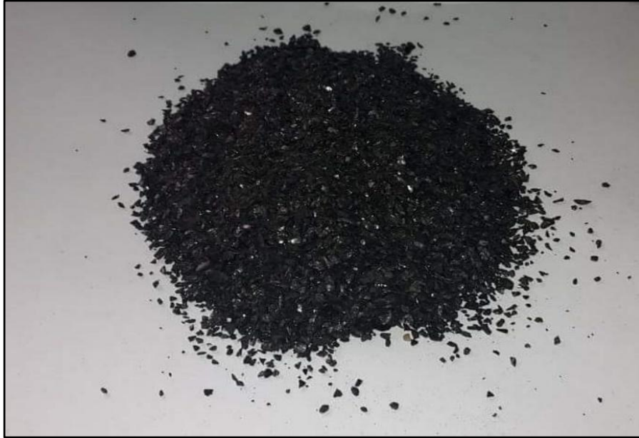
Figura 0.10. Carbón activado de cáscara de coco.
