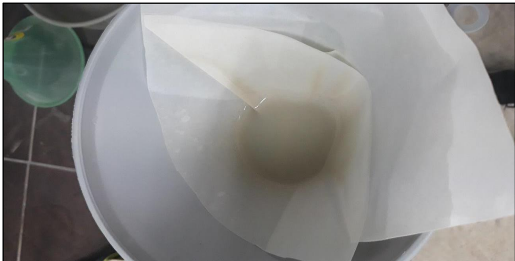
Figura 0.13. Filtrado de solución de cianuro con oro.
