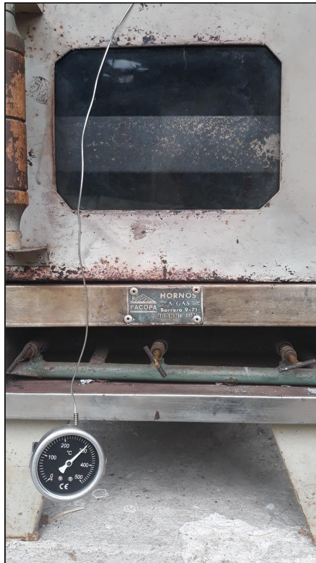
Figura 0.7. Horno a gas con termómetro a 300 °C.
