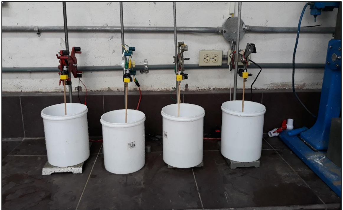
Figura 0.16. Equipo utilizado para agitación simultánea.
