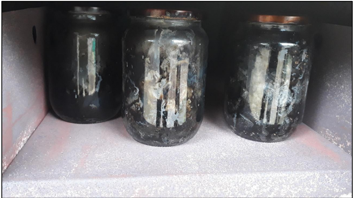
Figura 0.8. Envases con carbón dentro del horno.
