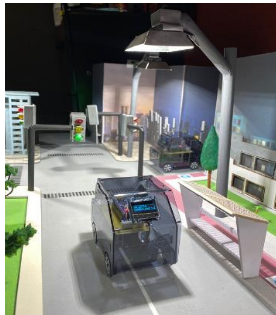
Fig. 14 Enlace Infraestructure-to-Vehicle (I2V) mediante VLC.
