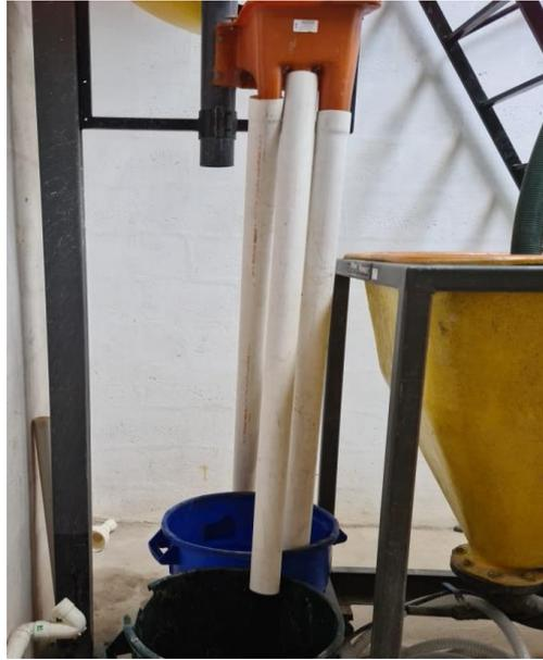
**Figura 2.11** Tubos PVC embonados en la salida de productos finales
