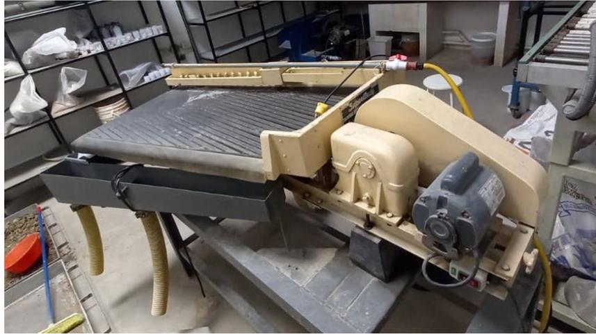
**Figura 2.9** Mesa vibratoria calibrada
