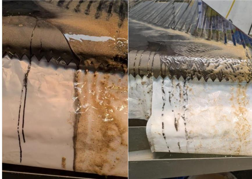
**Figura 3.1** Limpieza de separación en la mesa vibratoria con 3° de inclinación
