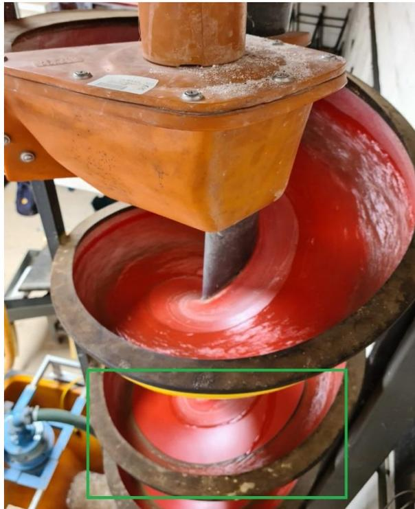
**Figura 3.3** Visibilidad de la separación en la espiral
