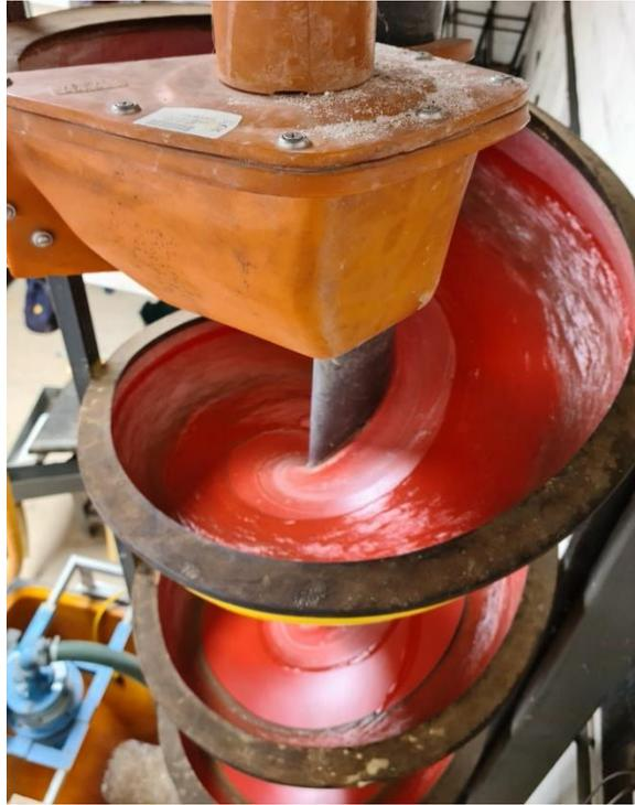
**Figura 2.16** Canales helicoidales realizando la separación de materiales
