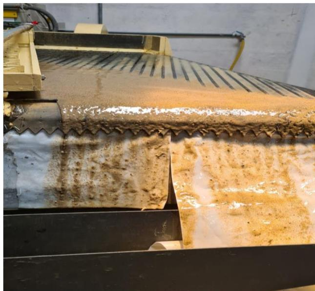
**Figura 3.2** Separación deficiente utilizando un ángulo de 2° de inclinación
