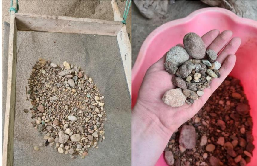
**Figura 2.4.** Material de desecho obtenido después del tamizaje
