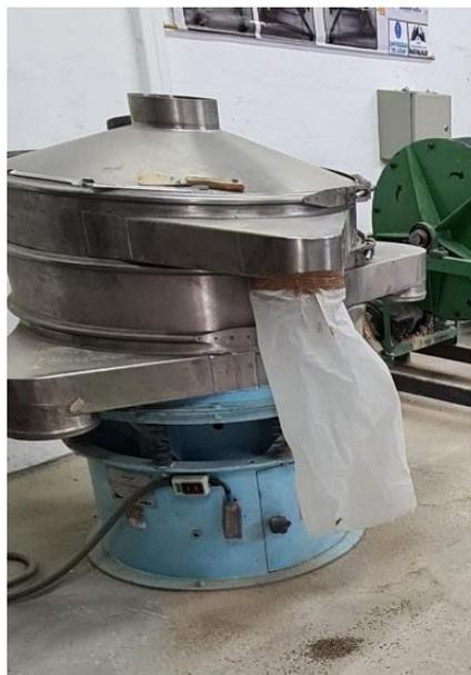
**Figura 2.5** Máquina tamizadora de vibración
