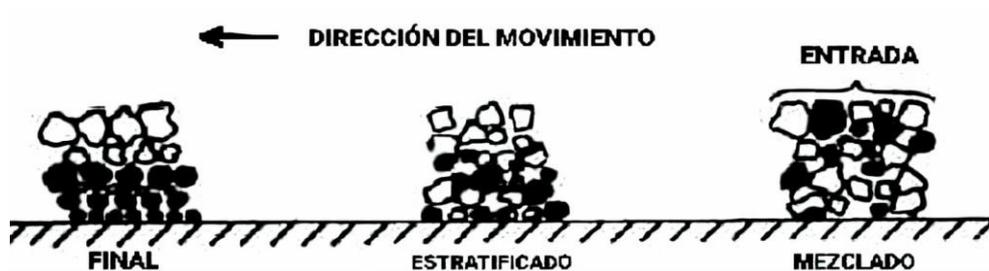
**Figura 1.10** Estratificación progresiva en los rifles
