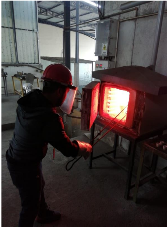
Figura 3.6. Colocación de muestras en el horno
