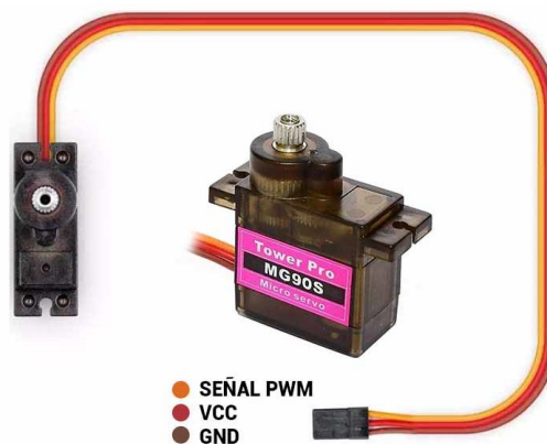
Figura 10. Pines del servomotor o actuador del exoesqueleto, mg90s.[20]
