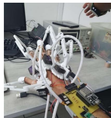
Figura 27. Diseño del sistema para rehabilitación de los dedos de la mano derecha.
