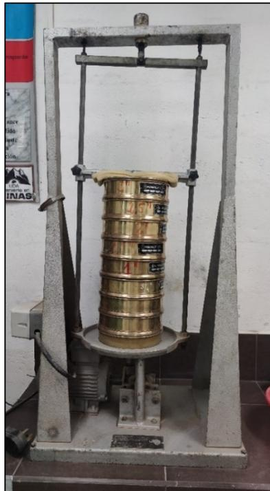
**Figura 2.8:** Juego de tamices y agitador mecánico
