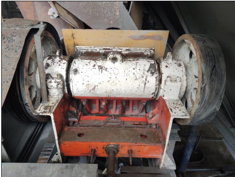
**Figura 1.36:** Trituradora de mandíbulas (secundaria)
