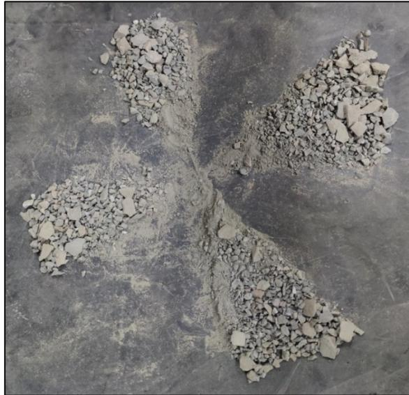
**Figura 2.5:** Cuarteo muestra (Descarga Trituradora #2)
