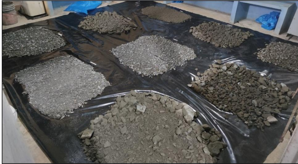
**Figura 2.2:** Secado natural del mineral
