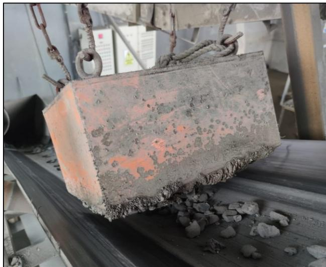
**Figura 1.34:** Equipo recolector de elementos no triturables
