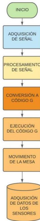
Figura 18. Diagrama de Flujo General del Funcionamiento de la Mesa Vibratoria
