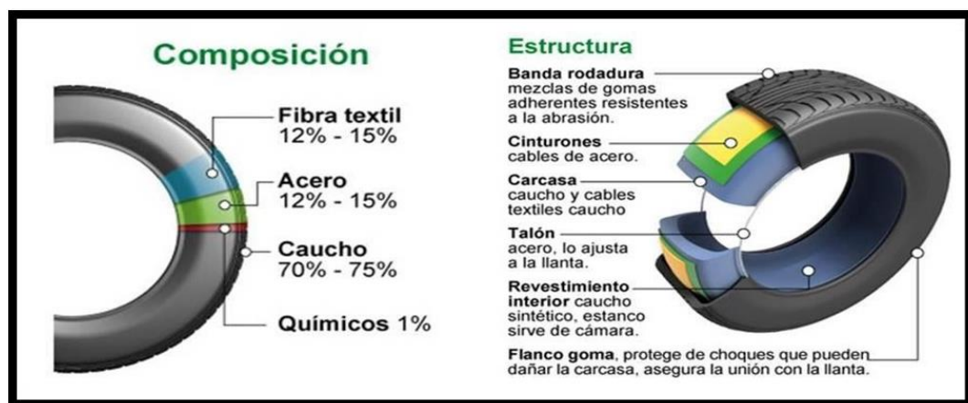
Figura 2.9 Estructura y composición de un neumático. Fuente: (Kévin, 2017)
