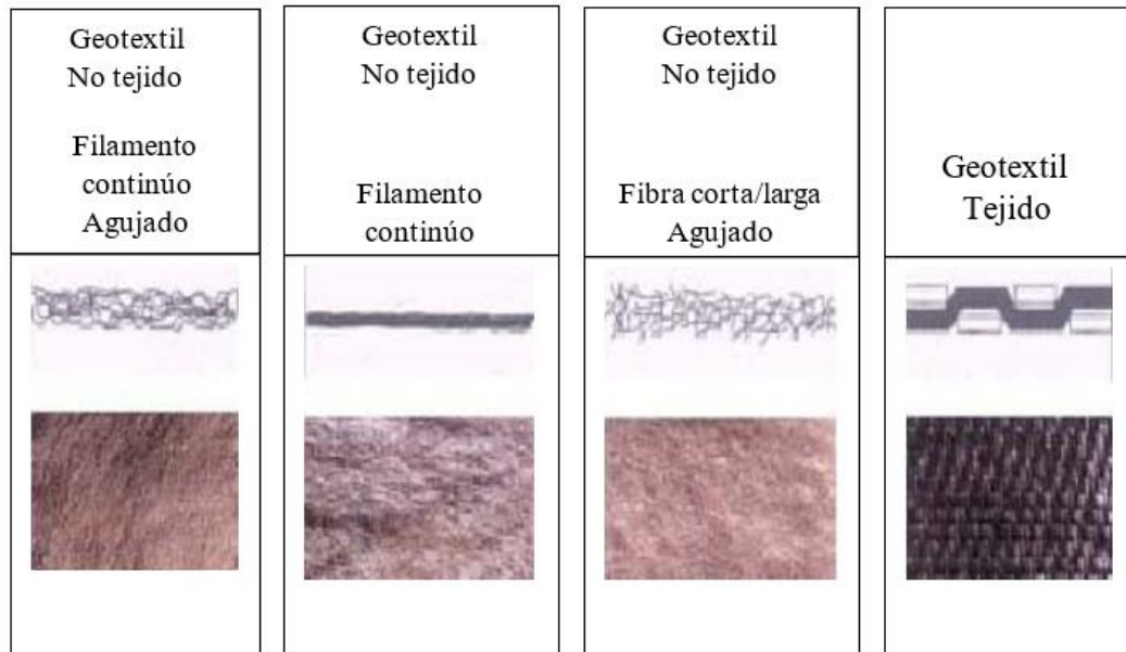
Figura 2.5 Características de los geotextiles. Fuente: (Piegari, 2005)
