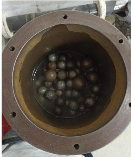
**Figura 3.12** Molino de bolas de laboratorio cargado.
