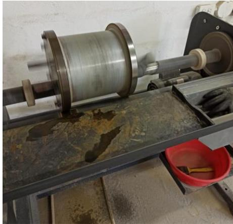
**Figura 3.2** Molino de bolas de laboratorio de la escuela de Ingeniería en Minas.
