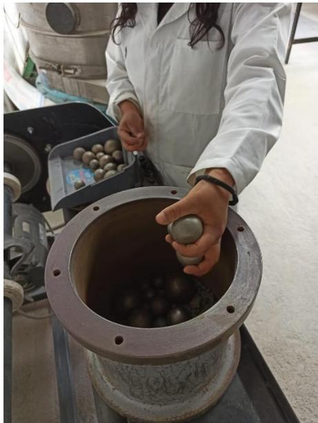
**Figura 3.11** Carga del molino de bolas de laboratorio.
