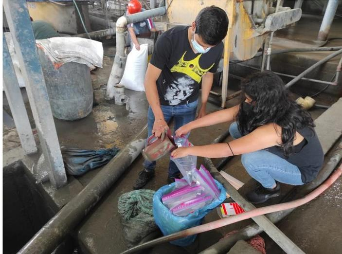
**Figura 2.10** Toma y recolección de muestras del molino chileno en planta.
