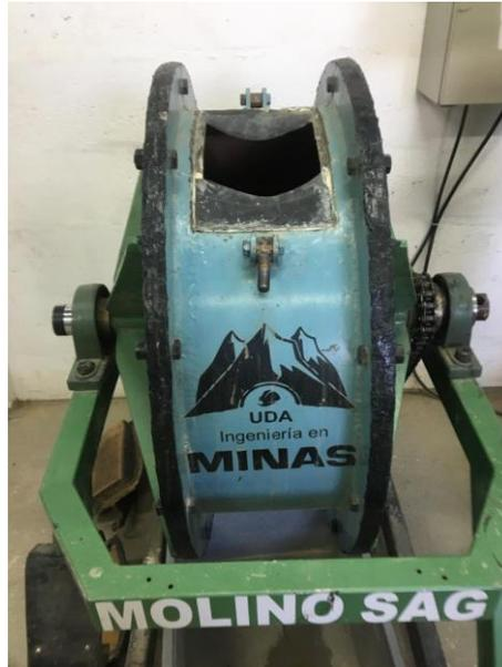
**Figura 3.1** Molino SAG del laboratorio.
