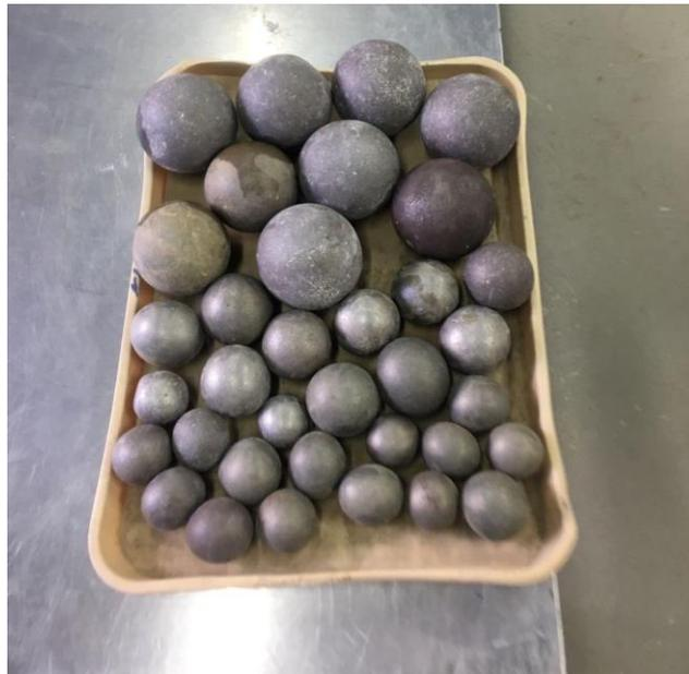
**Figura 3.4** Carga de bolas para el molino SAG.
