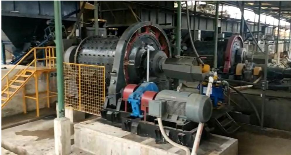
**Figura 2.4** Molino de bolas de planta.
