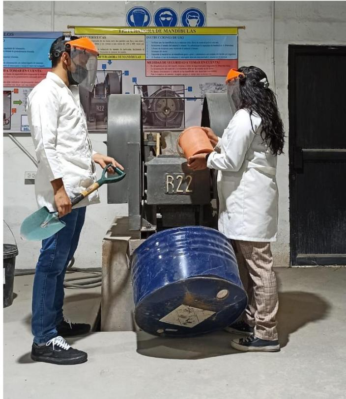
**Figura 3.3** Trituración de material en el laboratorio de la Escuela de Ingeniería en Minas de la Universidad del Azuay.
