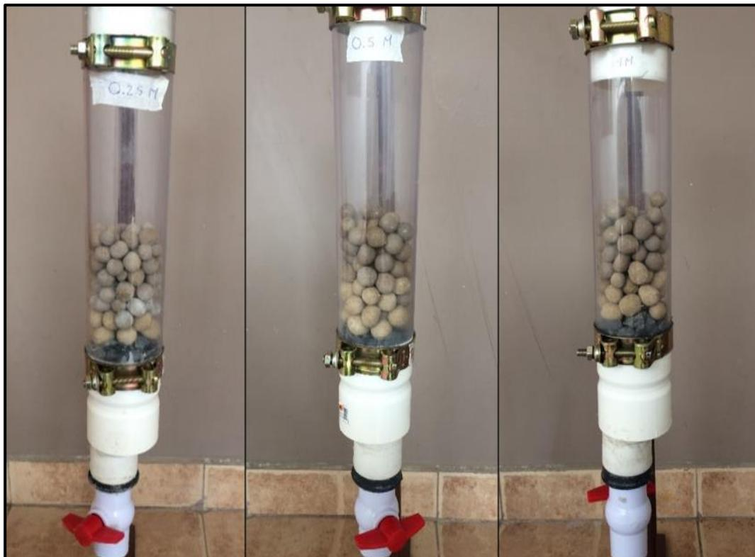
**Figura 2.16** Material aglomerado depositado en las columnas
