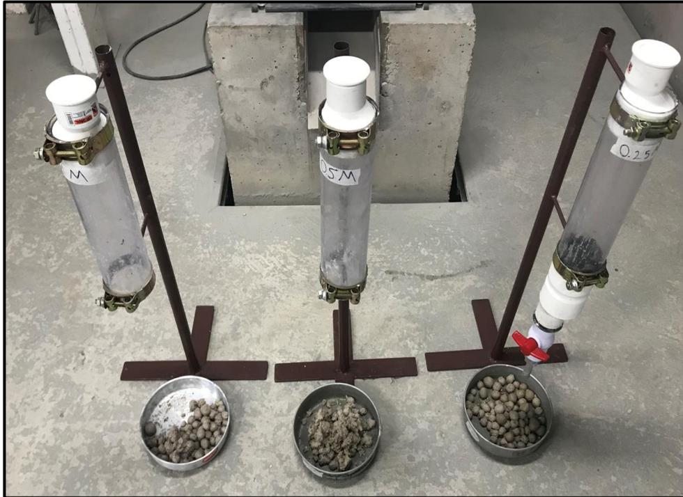
**Figura 2.19** Material sacado de las columnas luego del proceso de lixiviación
