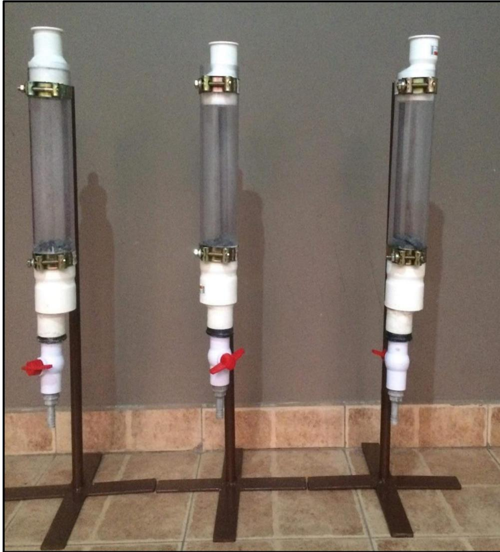
**Figura 2.14** Las tres columnas de lixiviación implementadas
