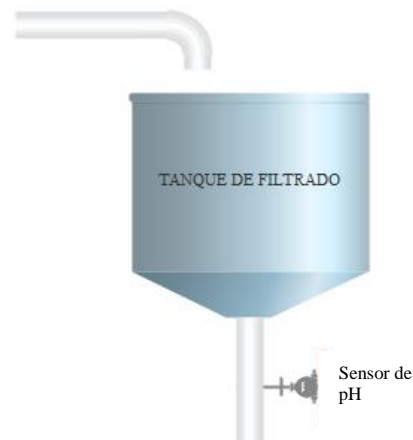
Figura. 27, Recepción de la materia prima y medición de pH.
