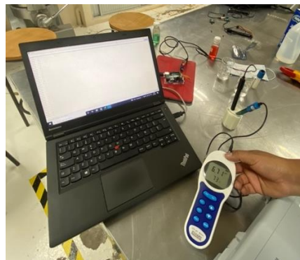
Figura.43 Calibración de sensores de pH mediante buffers
