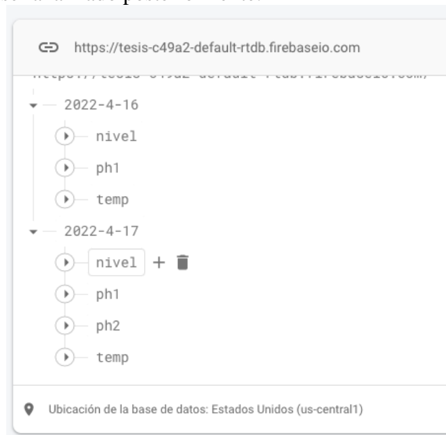
Figura.73. Prueba de recepción y almacenamiento de datos en Firebase.
