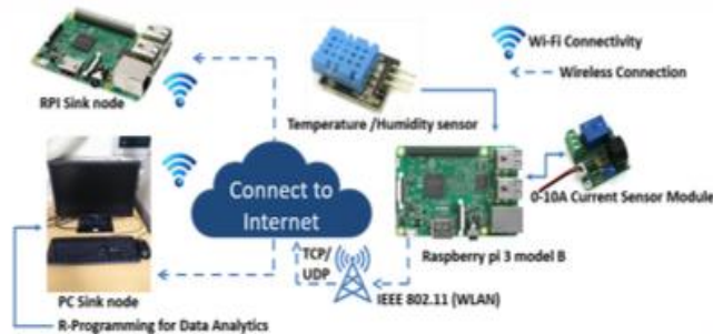
Figura.1. Esquema de funcionamiento de experimento de HVAC basado en IoT. [9]
