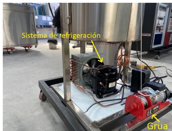
Figura. 36. Montaje de motor grúa y sistema de refrigeración
