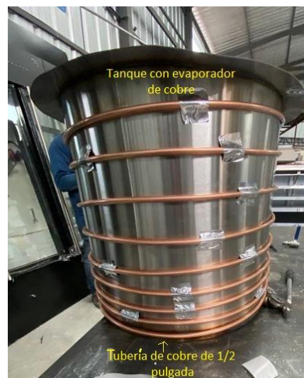
Figura. 33. Evaporador de tanque de leche (tubería de cobre enrollada en la placa del tanque).
