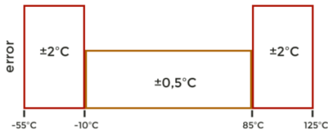
Figura.19, Variación de error según rangos de operación. [29]
