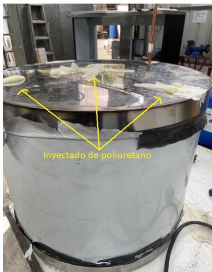
Figura.34 Inyectado de poliuretano.
