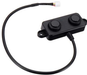
Figura. 20. Sensor ultrasonido HC-SR04 waterproof.[30]
