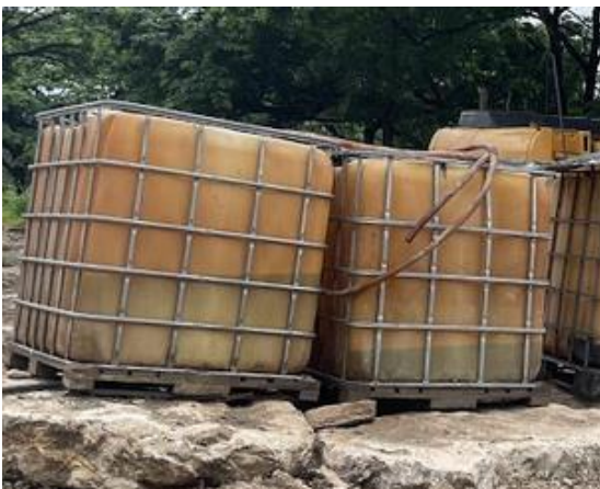
Ilustración 27. Falta de señalización. Fuente: Propia (2022).
