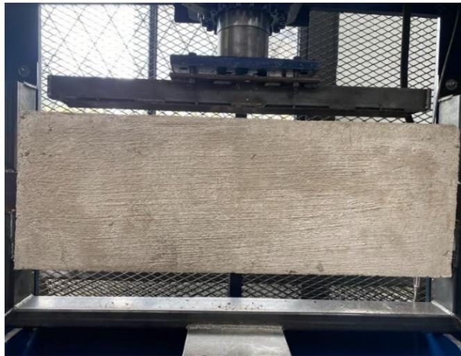
*Figura 3.1. Probeta número 1 dispuesta con conectores Hilti X-HVB previa a ser ensayada*
