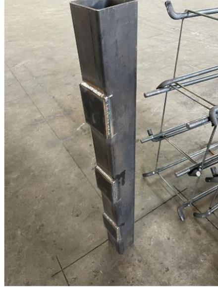
*Viga de acero (caja de 3mm) con platinas en la zona de instalación de los conectores de cortante*
