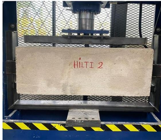
**Figura 3.4.** Probeta número 2 dispuesta con conectores Hilti X-HVB previa a ser ensayada
