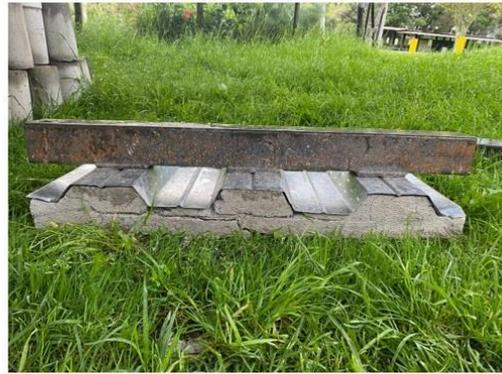
*Desprendimiento del hormigón de la placa colaborante*
