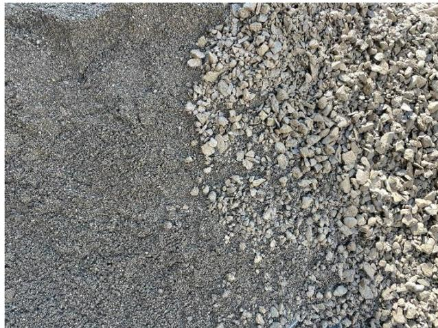
*Figura 2.4. Material triturado y arena proveniente del cantón Paute, utilizado para la elaboración de hormigón*
