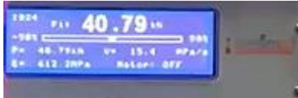
**Figura 3.17.** Resultado de resistencia última alcanzado en la prensa hidráulica una vez finalizado el ensayo número 3 Nelson Stud
