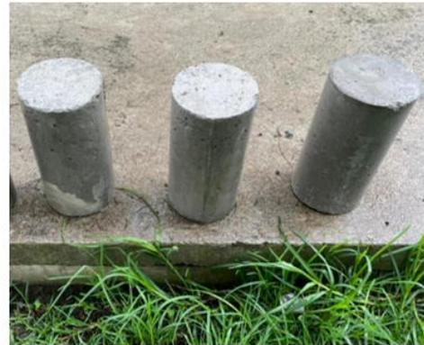
*Muestras del hormigón utilizado en los ensayos de laboratorio*
