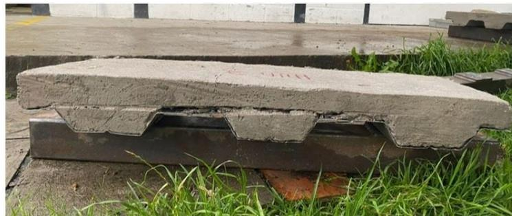
*Desprendimiento del hormigón de la placa colaborante*
