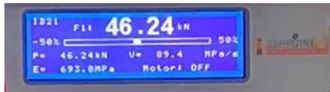
**Figura 3.14.** Resultado de resistencia última alcanzado en la prensa hidráulica una vez finalizado el ensayo número 2 Nelson Stud
