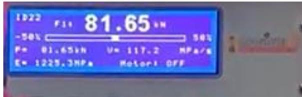
**Figura 3.8.** Resultado de resistencia última alcanzado en la prensa hidráulica una vez finalizado el ensayo. Probeta número 3 X-HVB
