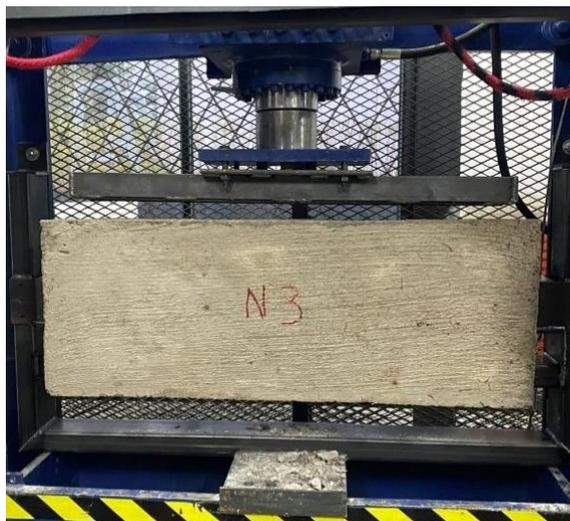
**Figura 3.16.** Probeta número 3 dispuesta con conectores tipo Nelson Stud BA o perno previa a ser ensayada
