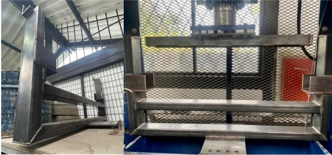
*Figura 2.27. Marco de acero acoplado en la prensa hidráulica para ejecutar el ensayo de esfuerzos cortantes*
