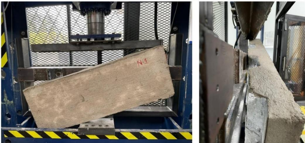
*Falla de la soldadura realizada entre la viga y los conectores de cortante, generando el desprendimiento parcial de la losa de la viga*
