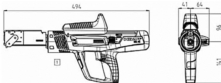
**Figura 1.15.** Pistola Hilti DX-76, para instalación de conectores de cortante X-HVB
