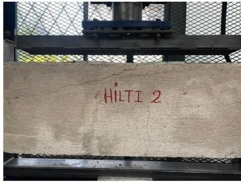
*Agrietamiento en el hormigón de la probeta número 2*
