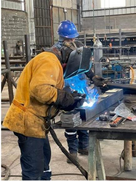
*Proceso de soldadura de platinas de 110 mm sobre la viga de acero*
