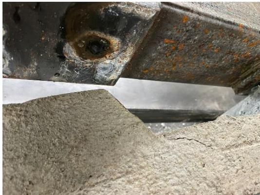
**Figura 3.18.** Punto de instalación del conector de cortante tipo Nelson Stud o perno en donde falló la sección compuesta ante fuerzas cortantes. Ensayo 3 Nelson Stud
