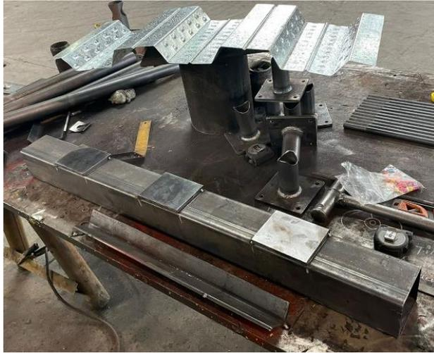
**Figura 2.21.** Implementación de platinas de 10mm de espesor en la zona de instalación de los conectores cortantes
