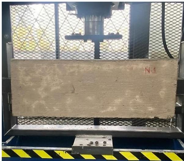
Figura 3.10. Probeta número 1 dispuesta con conectores tipo Nelson Stud BA previa a ser ensayada
