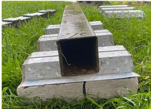
*Grieta generada por aplastamiento del conector de cortante sobre el hormigón*
