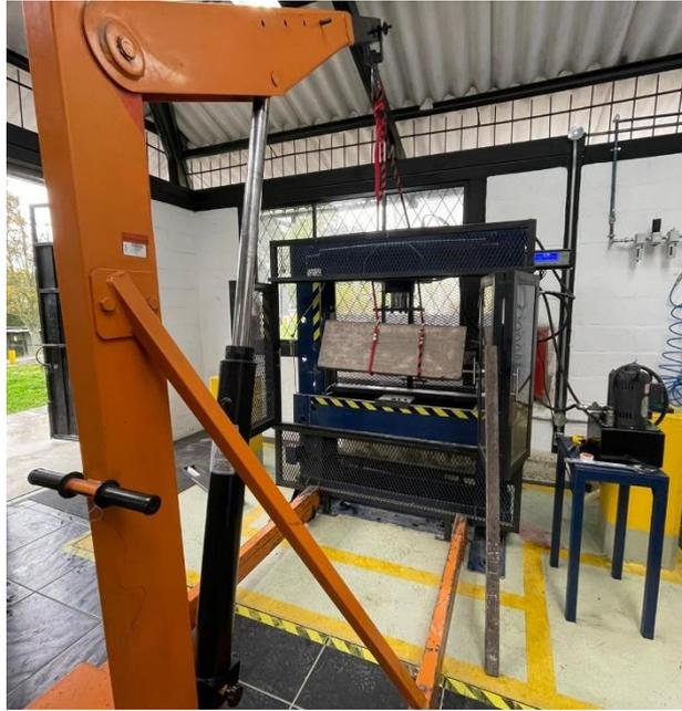
*Figura 2.29. Colocación de las probetas en el marco de la prensa con el uso de una grúa*
