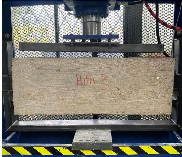
**Figura 3.7.** Probeta número 3 dispuesta con conectores Hilti X-HVB previa a ser ensayada
