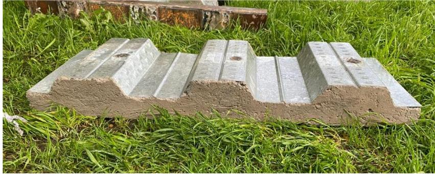
**Figura 3.19.** Losa desprendida de la viga debido a la falla de la soldadura en los puntos de anclaje. Ensayo 3 Nelson Stud
