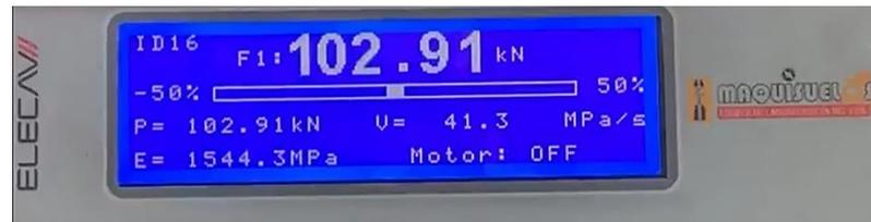
**Figura 3.2.** Resultado de resistencia última alcanzado en la prensa hidráulica una vez finalizado el ensayo. Probeta número 1 X-HVB
