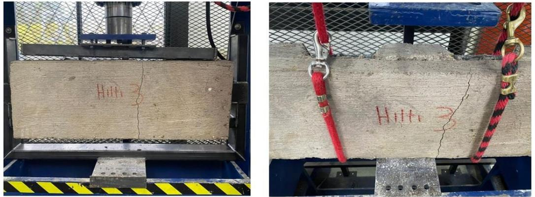
*Agrietamiento presentado en el hormigón de la probeta número 3*
