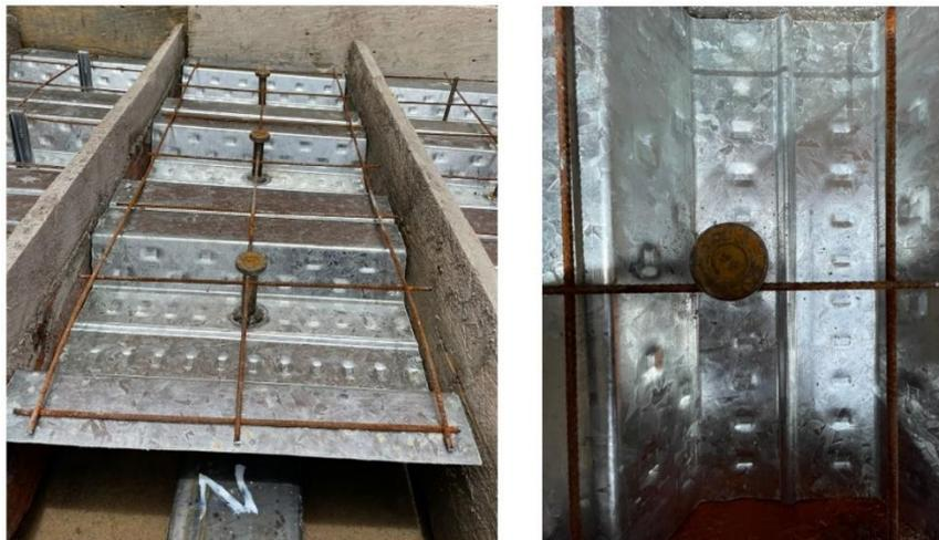
**Figura 2.24.** Colocación de malla electrosoldada y encofrado de las probetas
