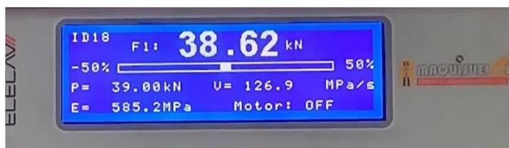
Figura 3.11. Resultado de resistencia última alcanzado en la prensa hidráulica una vez finalizado el ensayo. Ensayo número 1 Nelson Stud
