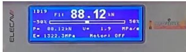
**Figura 3.5.** Resultado de resistencia última alcanzado en la prensa hidráulica una vez finalizado el ensayo. Probeta número 2 X-HVB
