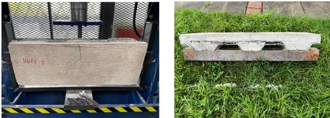
Agrietamiento en el hormigón de la probeta número 1 Desprendimiento del hormigón de la placa colaborante
