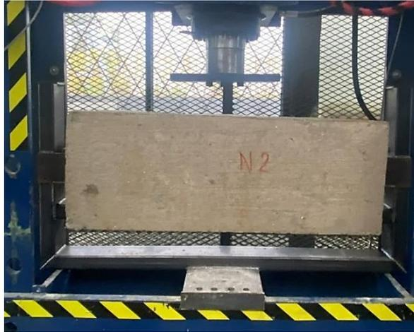
**Figura 3.13.** Probeta número 2 dispuesta con conectores tipo Nelson Stud BA o perno previa a ser ensayada
