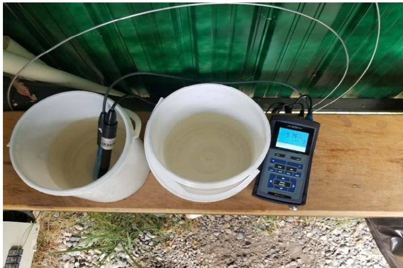
Figura 4.7 Sonda multiparámetros en funcionamiento
