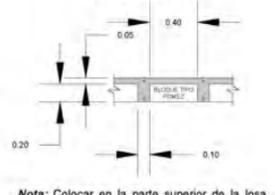
Nota: Colocar en la parte superior de la losa una malla electrosoldada tipo ARMEX R-126 a 2cm de la superficie.
