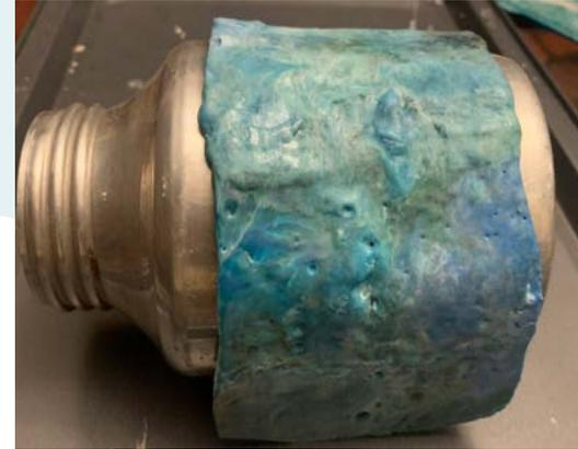
Figura 79. Foto de placa curvada sobre molde de metal.
