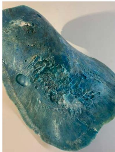
**Figura 77.** Foto curvado con pistola de calor
