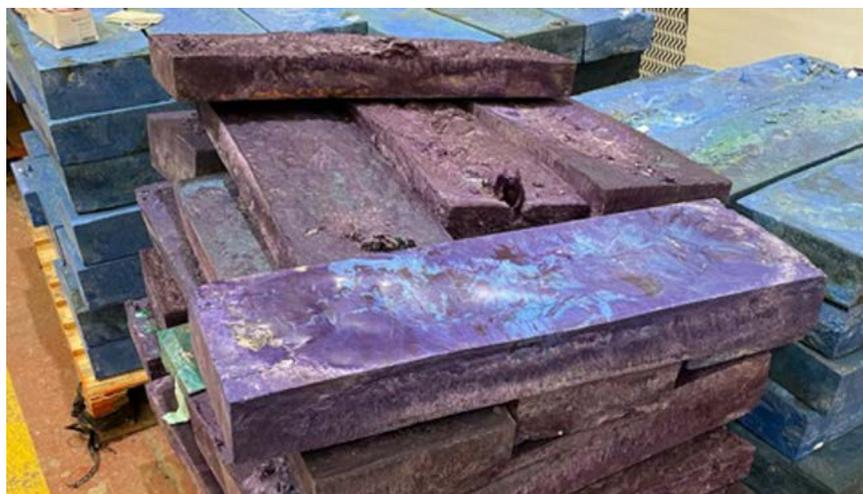
**Figura 9.** Bloques de polipropileno hechos de desechos de indumentaria de hospitales (BBC, 2020).
