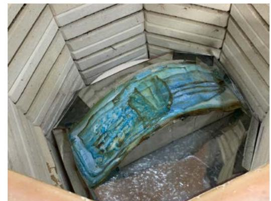
**Figura 73.** Foto después de una hora y 30 minutos, se puede ver como el material en vez de derretirse se empieza a quemar.
