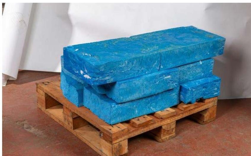
**Figura 10.** Bloques de polipropileno hechos de desechos de indumentaria de hospitales 2 (BBC, 2020).
