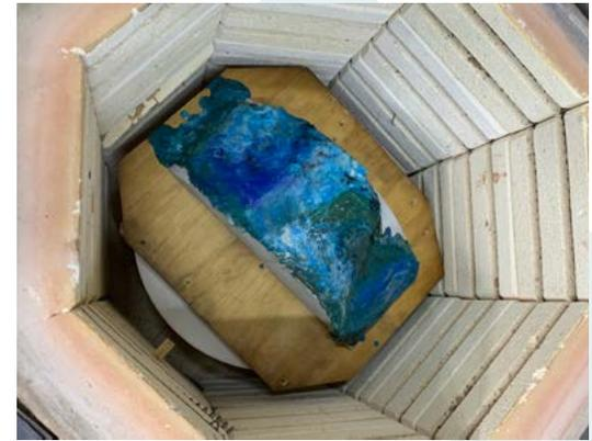
**Figura 70.** Foto de placa sobre el molde
