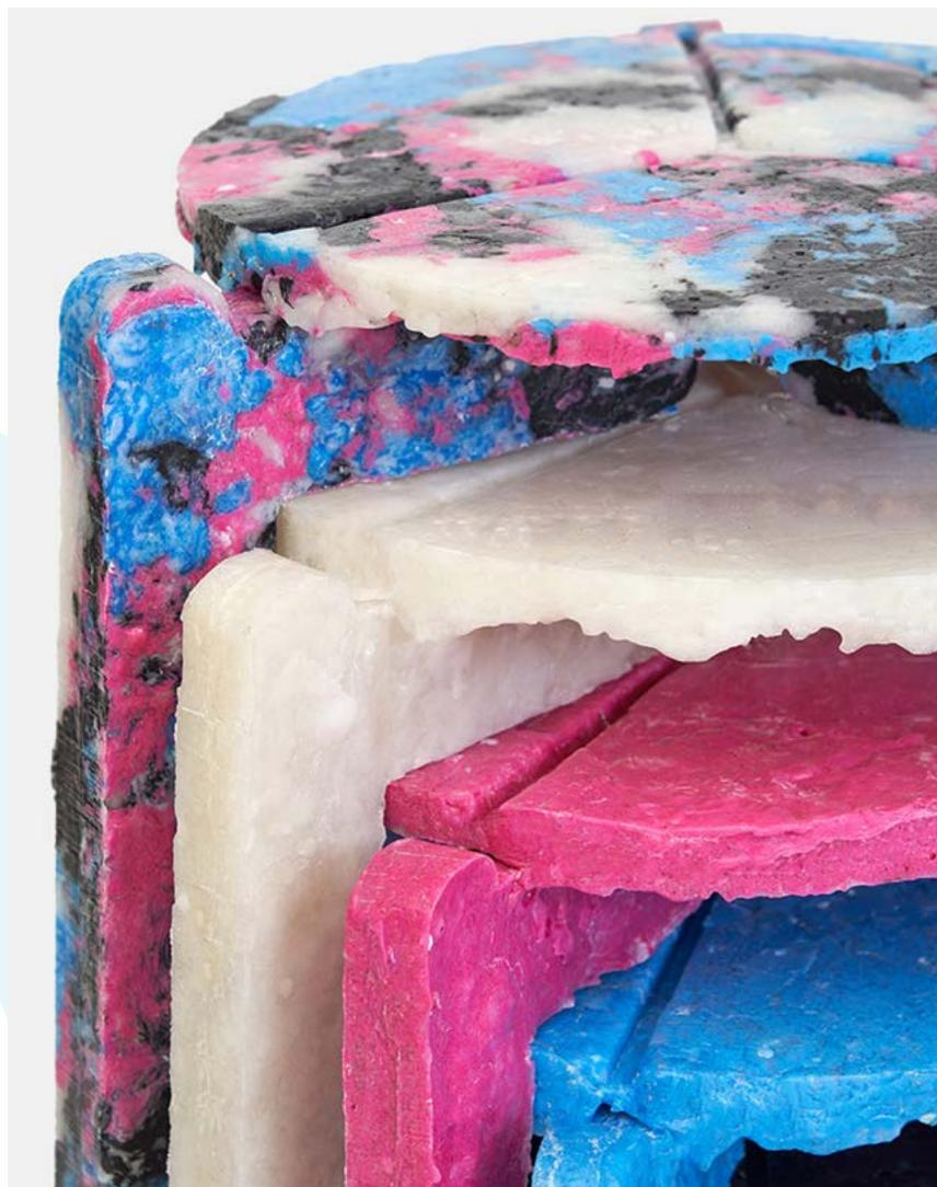
Figura 5. Detalle de bancos hechos de mascarillas.
