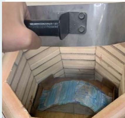
**Figura 71.** Foto después de 40 minutos con el horno a 180 grados en donde apenas se empezó a ver cambios.
