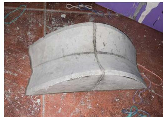
**Figura 66.** Foto del molde de cemento en la matriz
