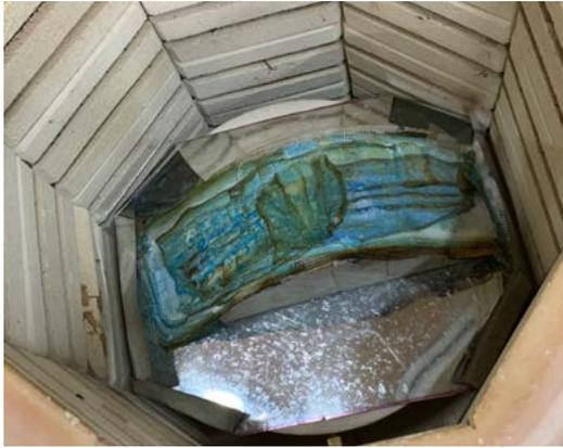
**Figura 74.** Foto después de una hora y 40 minutos, se ve que el material se está quemando por lo que se procedió a retirar la placa del horno.
